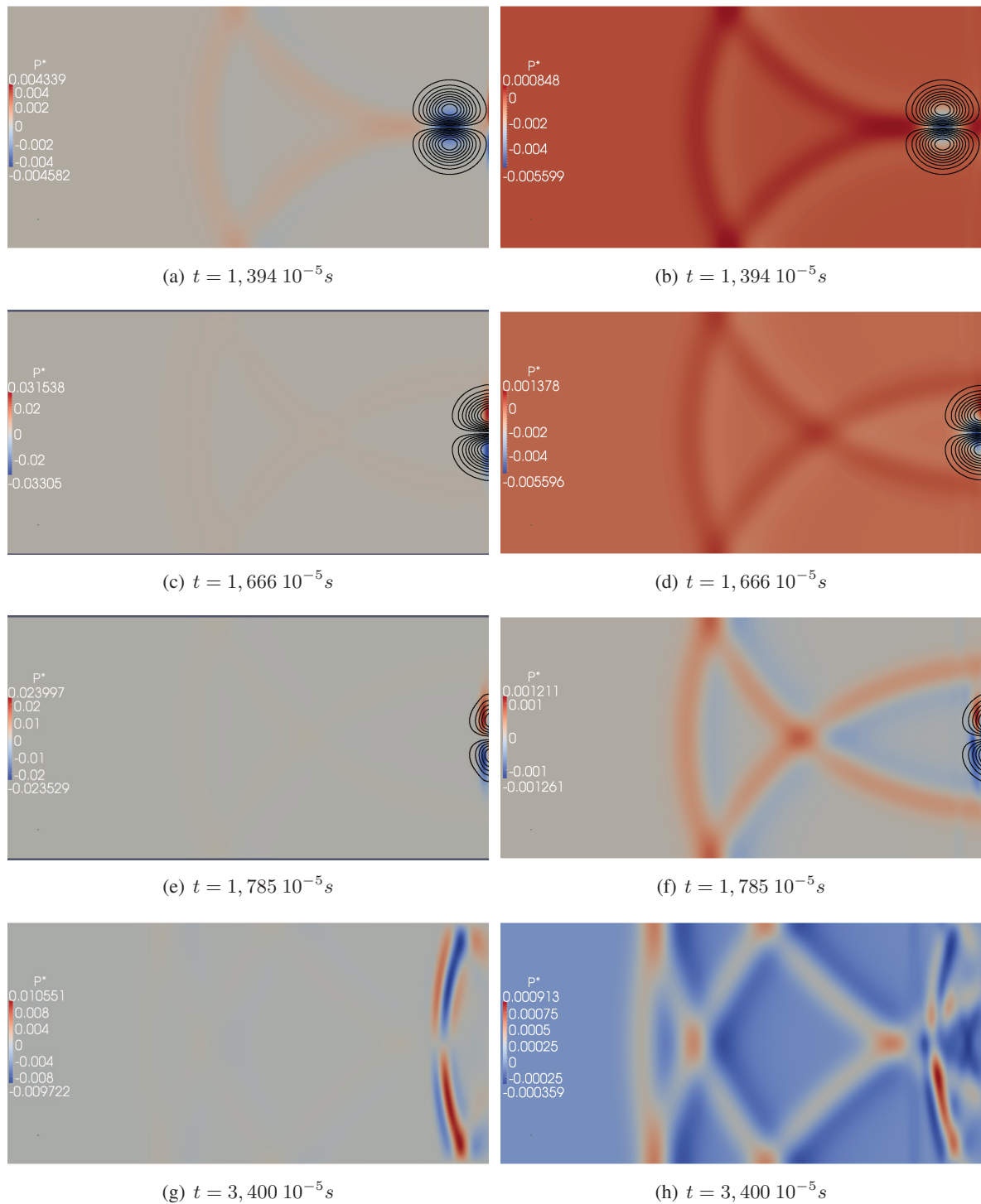
FIGURE 8.5: Configuration M3 : Sortie d'un vortex : M = 0.84 . Visualisation du champ instantané de pression normalisée et de contours de vitesse longitudinale obtenus avec un calcul NSCBC-1D (gauche) et NSCBC-3D (droite). L'évolution en temps se fait de haut en bas. Calculs EOS-cubique.
