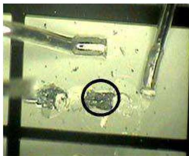
Figure 1-5 : Dégradation d'une métallisation d'une puce durant le procédé *wedge bonding*
