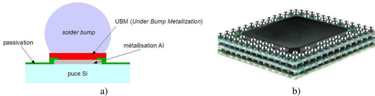
Figure 1-14 : Assemblage micro-électronique 3D avec la connectique *solder bumps*
