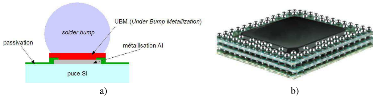
Figure 1-14 : Assemblage micro-électronique 3D avec la connectique solder bumps a) vue schématique en coupe [24], b) puce contenant des billes de brasure [25]
