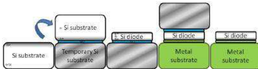
Figure 1-37 : Procédé synthétique de réalisation et report de matrices de composants à l'échelle du wafer [62]
