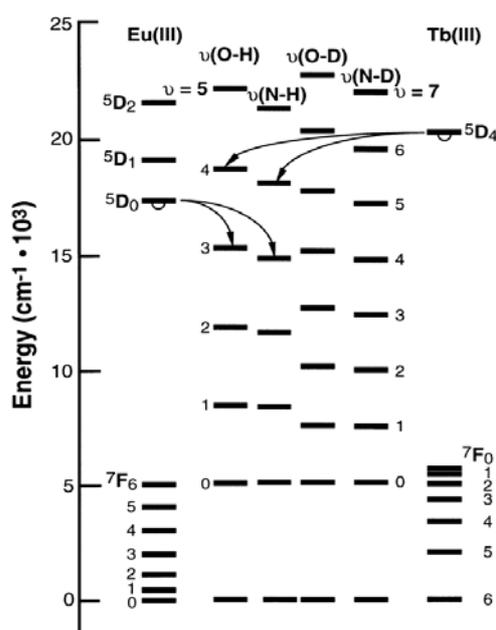
**Figure 3** : Niveaux d'énergie vibrationnelle des oscillateurs O-H, O-D, N-H et N-D, et des ions  $\text{Eu}^{3+}$  et  $\text{Tb}^{3+}$ . Les demi-cercles indiquent les principaux niveaux luminescents des ions. Les flèches représentent les processus de désexcitation non-radiative par transfert d'énergie vers les oscillateurs.<sup>15</sup>
