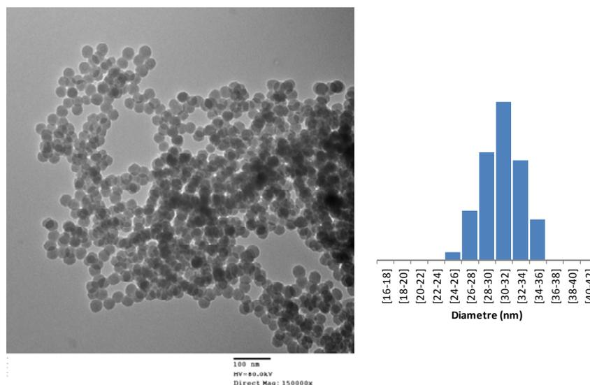
**Figure 63** : Cliché MET des nanoparticules luminescentes fonctionnalisées en surface par des fonctions amines, NP-Eu(**43**)<sub>3</sub>-NH<sub>2</sub>.
