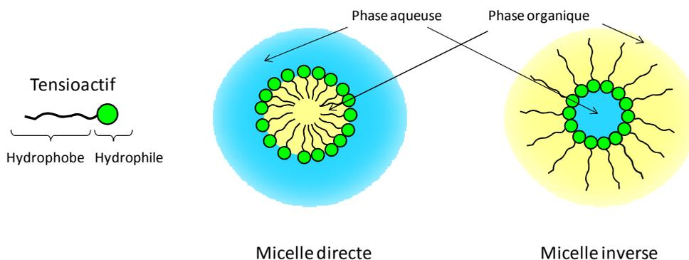
**Figure 18** : Représentation d'une micelle directe et d'une micelle inverse.
