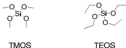
**Figure 17** : Structure des alcoxyasilanes TMOS et TEOS.
