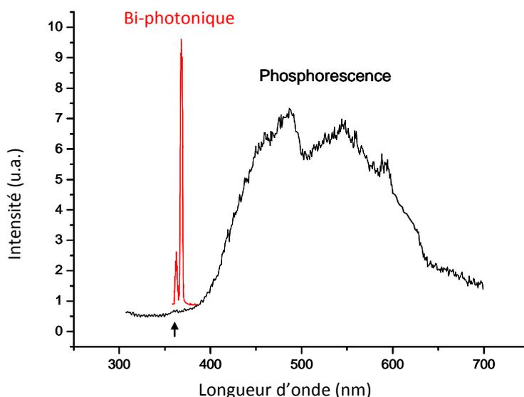
**Figure 60 :** Spectre d'émission du nanohybride NP-Gd(**43**)<sub>3</sub> obtenu à  $\lambda_{exc} = 287$  nm, correspondant à la phosphorescence du ligand (en noir). En rouge, bande d'excitation attribuée à la transition  $S_0 \rightarrow T_1$  (avec  $\lambda/2$ ).
