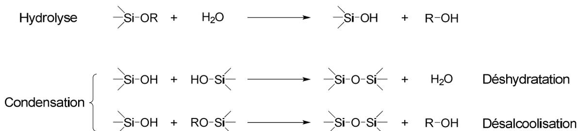
**Schéma 3** : Hydrolyse des alcoxyasilanes, puis condensation des silanols menant à la formation du réseau de silice.
