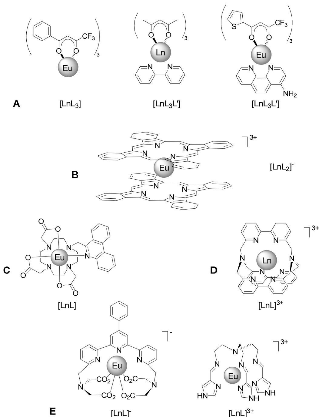
**Figure 7** : Exemples de complexes luminescents de lanthanide (**A** : dicétonates<sup>20</sup> ; **B** : complexe de phthalocyanine<sup>21</sup> ; **C** : cyclène<sup>22</sup> ; **D** : cryptate<sup>23</sup> ; **E** : podates<sup>24,25</sup>).
