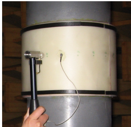
FIGURE 4.13 – Excitation au marteau d'un revêtement de type « PE/PMP » collé sur un cylindre rigide, et mesure de l'accélération en un point situé à environ 17^\circ du point d'application de la force.
