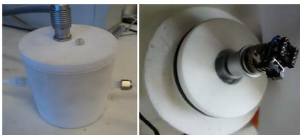
Figure III.9 : Cellule de test sous gaz
