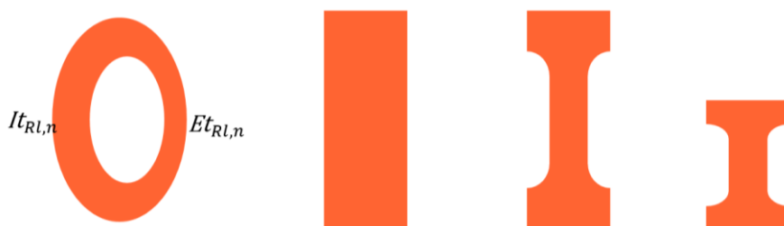
fig. 4.1 Illustration des géométries testées dans ce chapitre (lamelle, éprouvettes de traction et de micro-traction)
