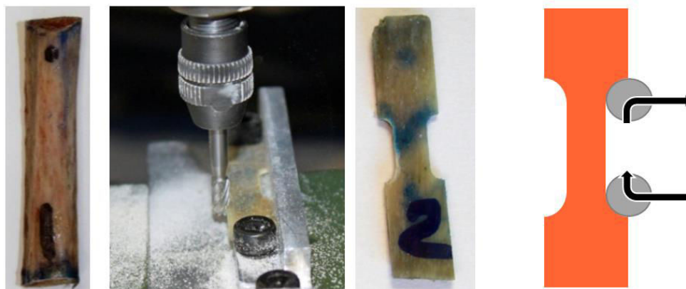
fig. 4.2 Usinage des éprouvettes d'os cortical d'après les lamelles.
