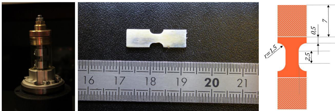
fig. 4.26 Cellule de micro-traction, éprouvette de microtraction et dimensions.
