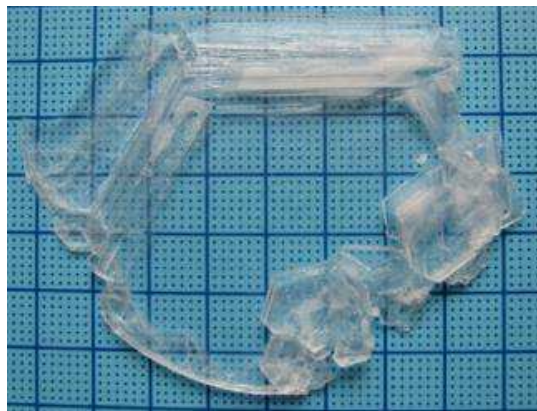
Figure 3.4 : monocristal de KBBF d'épaisseur 3,7 mm obtenu par nucléation spontanée à partir du mélange KBBF – KF – B 2 O 3 [18].
