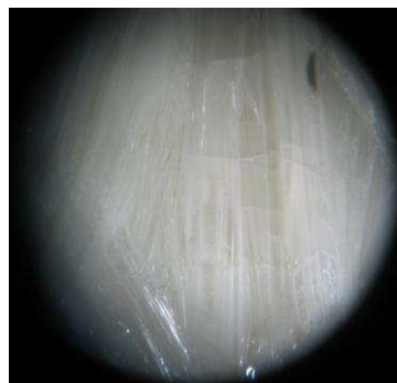
Figure 2.32 : photo du mélange de composition 40 CBF – 60 CaF 2 à l'issue du refroidissement lent.
