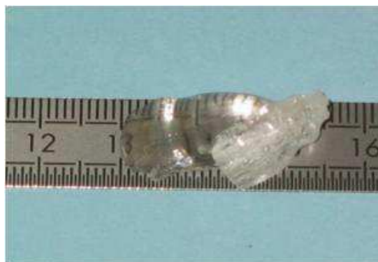
Figure 2.10 : monocristal de CBF synthétisé à partir d'un bain de composition 80 CBF – 20 LiF (% massique) par la technique Czochralski.
