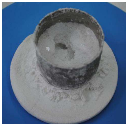
Figure 3.36 : bain du cristal YAB 6 à la fin de la croissance.
