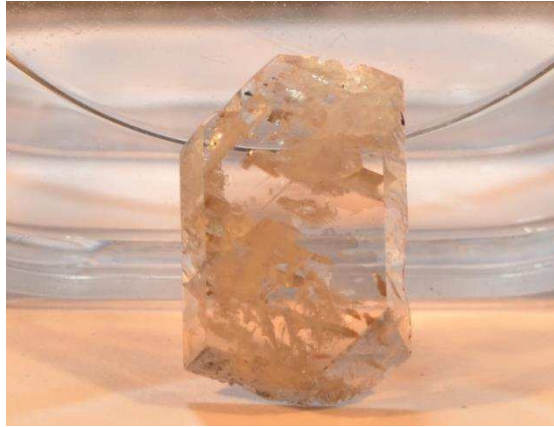
Figure 3.66 : photo d'une tranche de YAB 7 coupée parallèlement à \vec{c} présentant de nombreuses inclusions.
