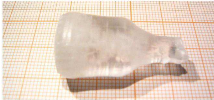
Figure 2.13 : monocristal de CBF synthétisé à partir d'un bain de composition 20 CBF – 72,5 LiF – 7,5 B 2 O 3 (% mol) par la technique Czochralski [44].
