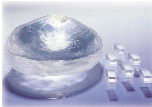
Figure 3.1 : monocristal de \beta - BBO produit par la société chinoise Castech [6].
