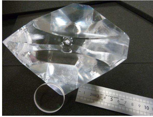
Figure 2.1 : monocristal de LBO produit par la société française Cristal Laser [9].
