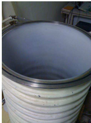
Figure 2.25 : intérieur de la cuve du four Czochralski tapissée d'une fine poudre blanche due à la l'évaporation du bain durant la croissance.
