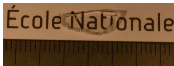
Figure 2.37 : photo d'une lame de CBF 6 d'épaisseur 1,2 mm coupée perpendiculairement à la direction de croissance.
