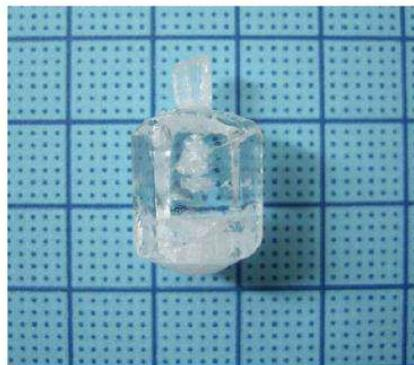
**Figure 3.23** : cristal de YAB de dimensions  $16 \times 16 \times 18 \text{ mm}^3$  synthétisé dans le flux  $\text{Li}_2\text{O} - \text{B}_2\text{O}_3$  [72].
