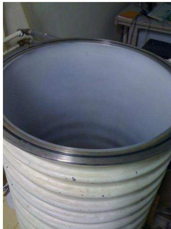
**Figure 2.25** : intérieur de la cuve du four Czochralski tapissée d'une fine poudre blanche due à l'évaporation du bain durant la croissance.
