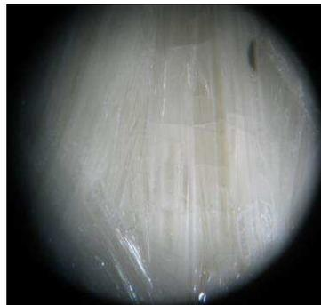
**Figure 2.32** : photo du mélange de composition 40 CBF – 60 CaF<sub>2</sub> à l'issue du refroidissement lent.
