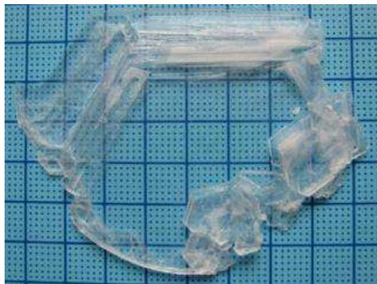
**Figure 3.4** : monocristal de KBBF d'épaisseur 3,7 mm obtenu par nucléation spontanée à partir du mélange KBBF – KF – B<sub>2</sub>O<sub>3</sub> [18].
