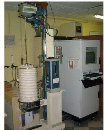
**Figure 1.15** : Schéma du montage Czochralski et photo du dispositif.
