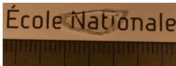
**Figure 2.37** : photo d'une lame de CBF 6 d'épaisseur 1,2 mm coupée perpendiculairement à la direction de croissance.
