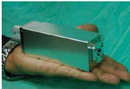
**Figure 3.2** : photographie d'un prototype de microlaser utilisant BBO comme cristal non linéaire pour la GSH à 266 nm [7]
