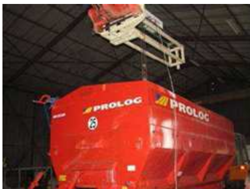
Figure 2.15 – Mesure de compaction du compost dans la trémie à l'aide du pénétromètre
