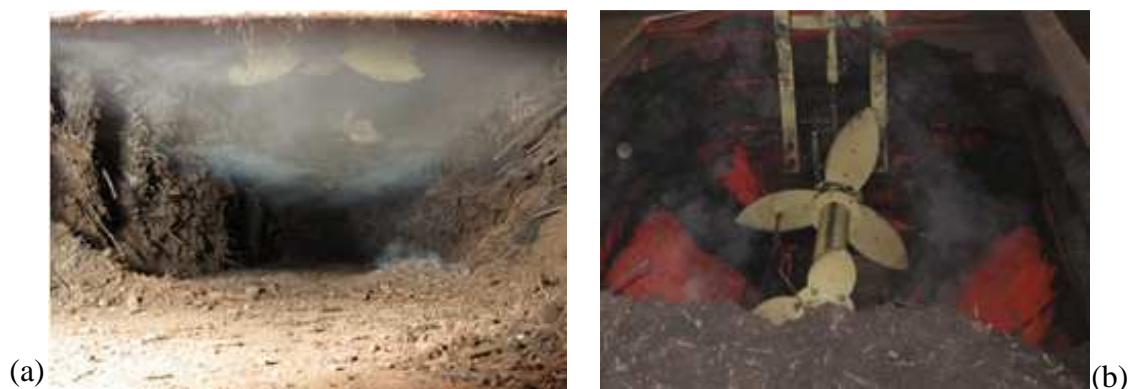
Figure 4.8 – (a) Voûte formée sous la poutre ; (b) Partie arrière de la caisse vidée après action de la poutre
