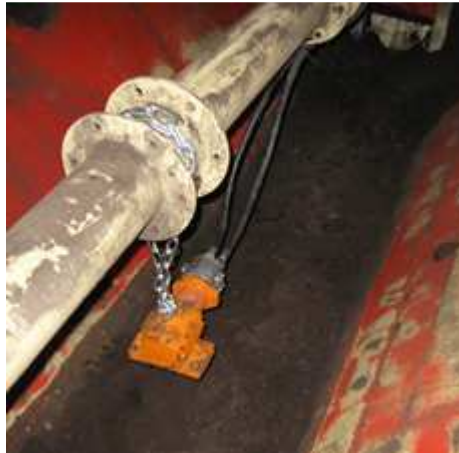
Figure 4.15 – Vibreur suspendu à la partie arrière de la poutre longitudinale
