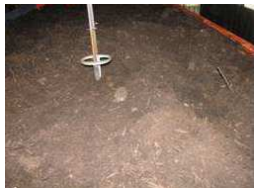
Figure 2.15 – Mesure de compaction du compost dans la trémie à l'aide du pénétromètre
