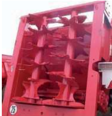
Figure 2.3 – Dispositif d'épandage à hérissons verticaux [Cem07]
