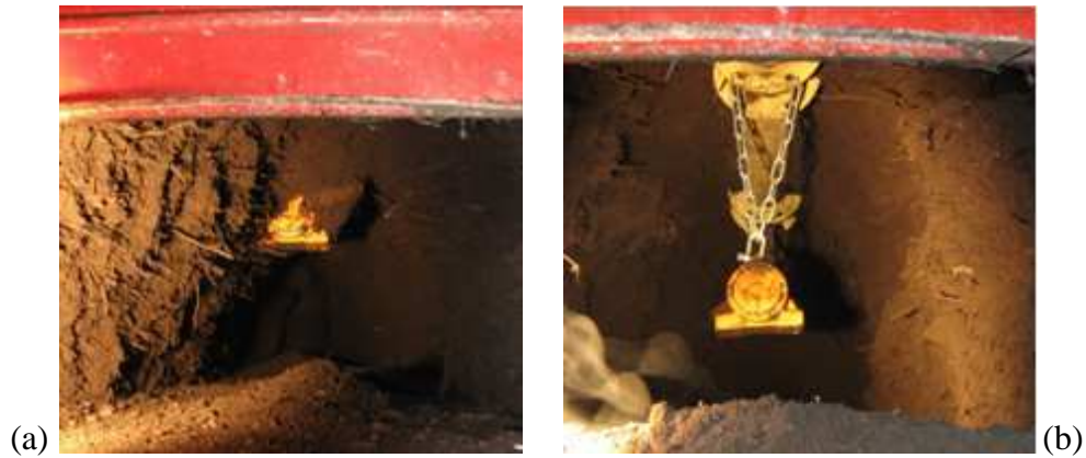
Figure 4.16 – (a) Voûte formée sous la poutre (avant l'action du vibreur) ; (b) Maintien de la voûte formée après l'action du vibreur
