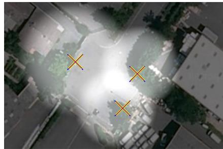
**FIGURE 3.11:** Potentiel de localisation sur les exemples d'amers de la figure 3.9. Couplage du modèle de visibilité avec la prise en compte de la position des amers et des capacités de localisation du robot.
