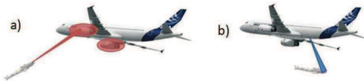
FIGURE I.2 - Schéma du fonctionnement de la contre-mesure optique : a) Le missile est guidé par la chaleur des moteurs de l'avion – b) Le laser aveugle le détecteur thermique du missile qui est dérivé de sa trajectoire.
