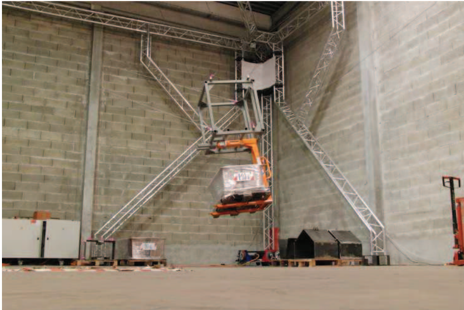
FIGURE 5.19 : Plate-forme du démonstrateur du projet COGiRO chargée avec une palette de 110 kg à la quatrième pose de traj 4 .
