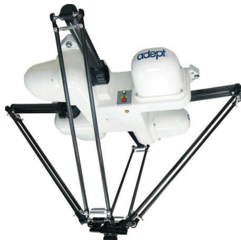
FIGURE 1.1 : Le Adept Quattro™ s650H, un robot parallèle à bras rigides.
