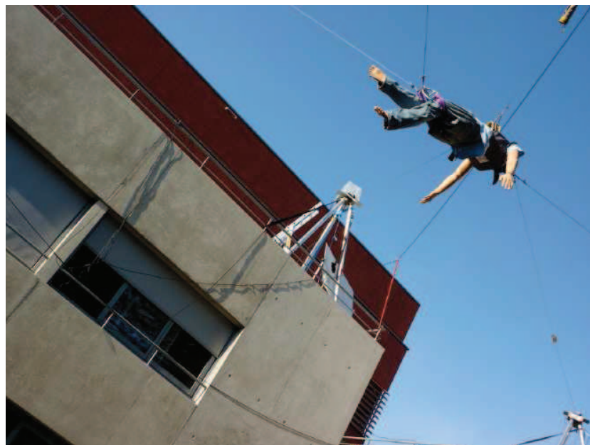
FIGURE 1.9 : Mise en situation du robot de secours MARIONET-CRANE, développé à l'INRIA Sophia-Antipolis par l'équipe projet COPRIN.
