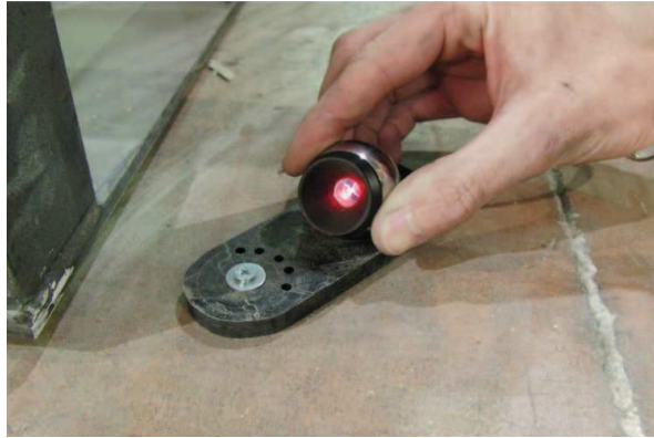
FIGURE 5.14 : Une des bases au sol de la cible du laser de poursuite.
