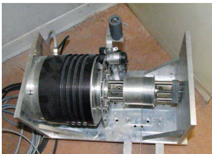
FIGURE A.3 : Photographie d'un enrouleur de REELAX8.
