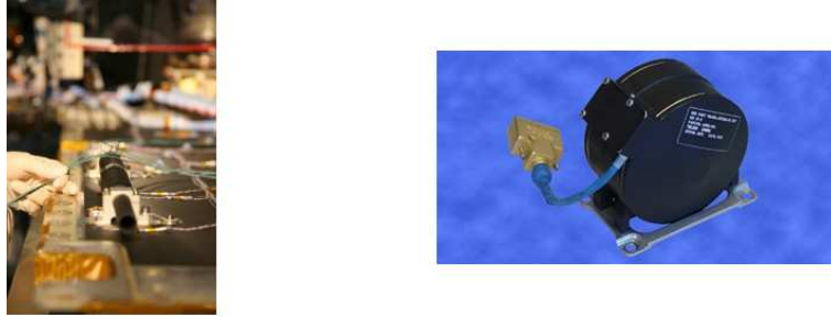
FIGURE 1.4 – Actionneurs utilisés dans le mode MNO de Myriade - magnéto-coupleur (à gauche) et roue à réaction (à droite)
