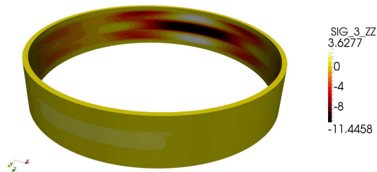
FIGURE 2.21 – Contrainte \sigma_{zz} au voisinage du trou (géométrie dilatée 10 fois dans le sens de l’épaisseur)
