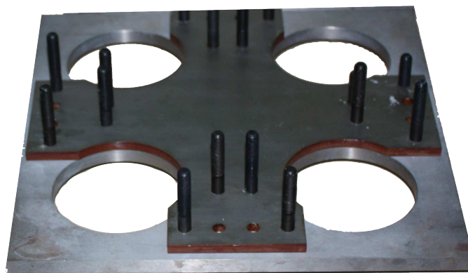
FIGURE B.3: Montage de collage des éprouvettes sandwich.
