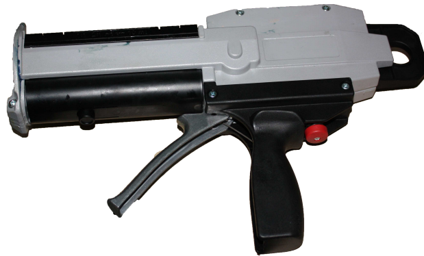
FIGURE B.2: Pistolet doseur et mélangeur de colle.
