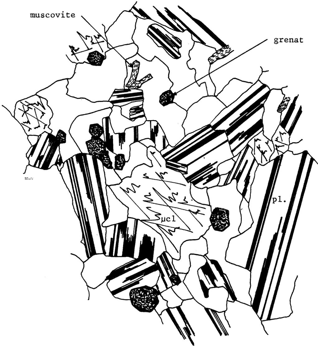
FIGURE III-21. - Granite à grain fin riche en grenat (lame U92). (x100)
