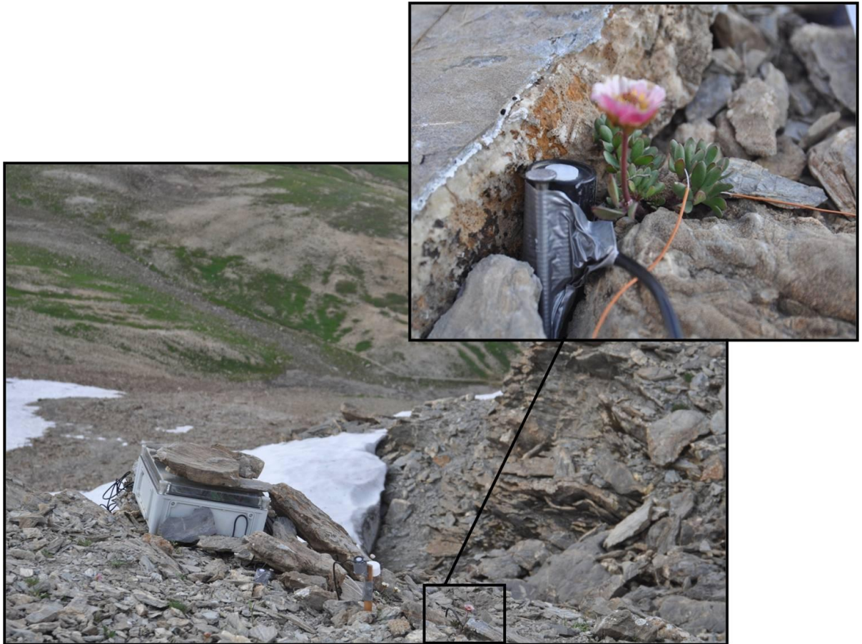
(Fig.4) La centrale d'acquisition CR23X a été installée au dessus du col du Galibier, pour mesurer les températures de plusieurs feuilles et de l'air (le thermocouple permettant la mesure de la température de l'air est situé sous le bouchon en plastique blanc visible sur la photo), et l'intensité lumineuse reçue par les feuilles (photo prise le 28.06.11).
