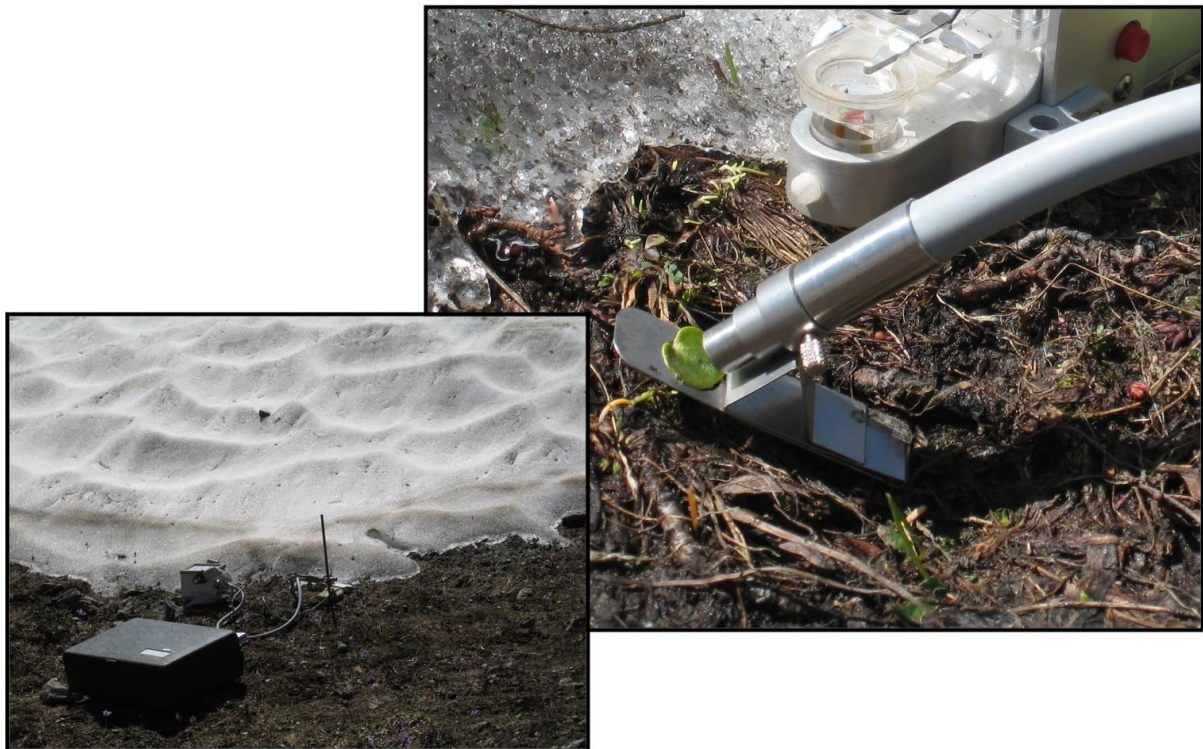
(Fig. 5) Exemple de mesure de la fluorescence chlorophyllienne sur le terrain, avec un mini PAM.
