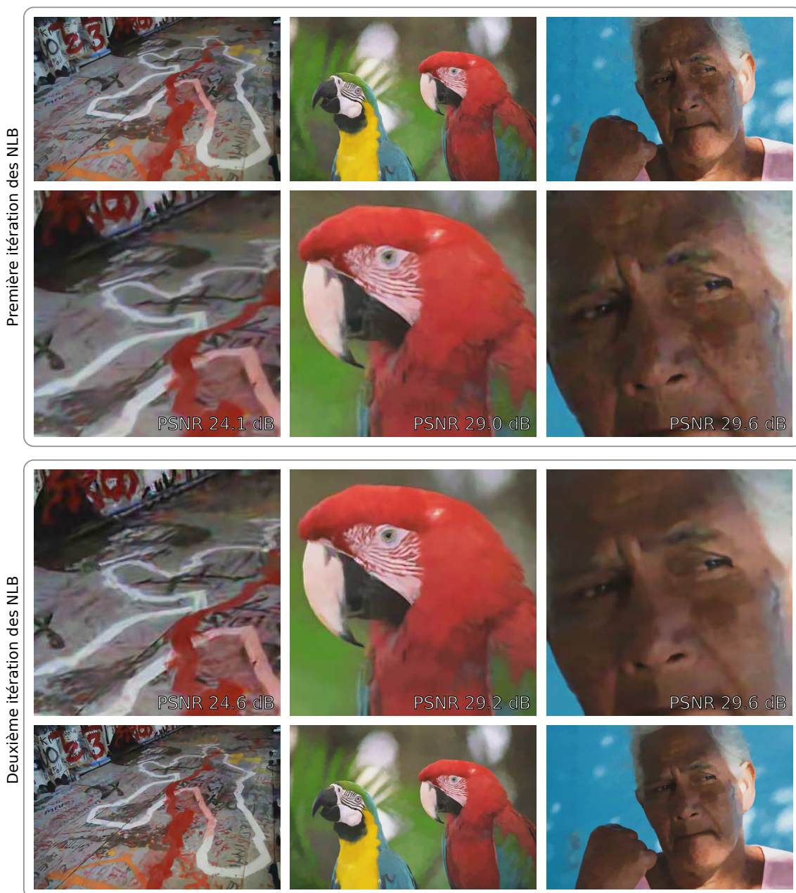
FIGURE 5.5: Images débruitées obtenues après la première et la deuxième itération de notre CovTree-NLB à partir de trois images corrompues par un bruit additif gaussien d'écart type 0.2. Afin de mieux comparer les performances, nous fournissons des agrandissements des trois images sur les deux lignes centrales.
