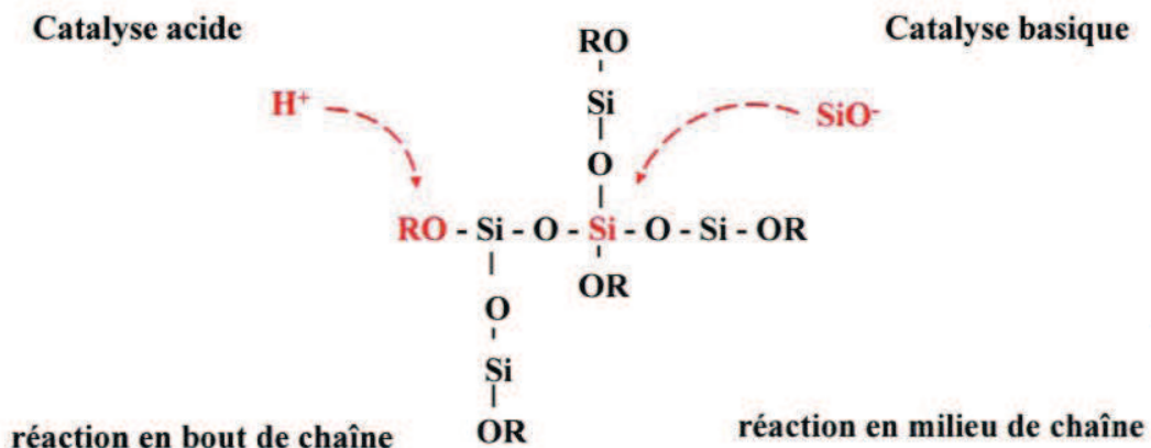
Figure 19 : Représentation des sites réactifs en fonction du type de catalyse (Corriu et al. 2008)
