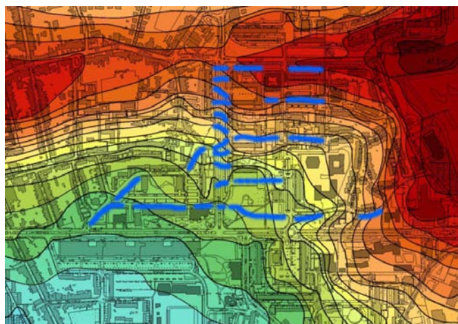
Figure 48 : Écoquartier de Mons-en-Baroeul, l'écoulement de l'eau dans la pente (Étude de définition, 2005)
