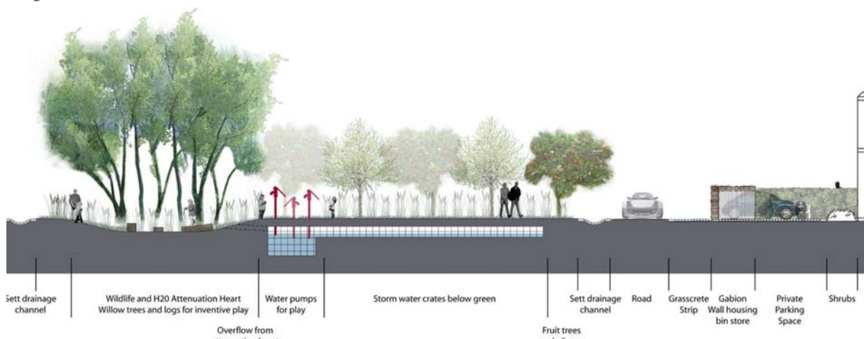
Figure 56 : The Triangle, Swindon, Wiltshire Royaume-Uni, coupe du système de drainage urbain durable (Engleback, 2012)
