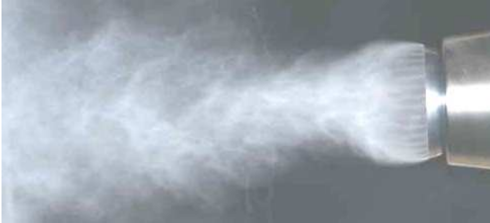
Figure 10.4: Bol rotatif en fonctionnement [94], cliché J. Balcaen
