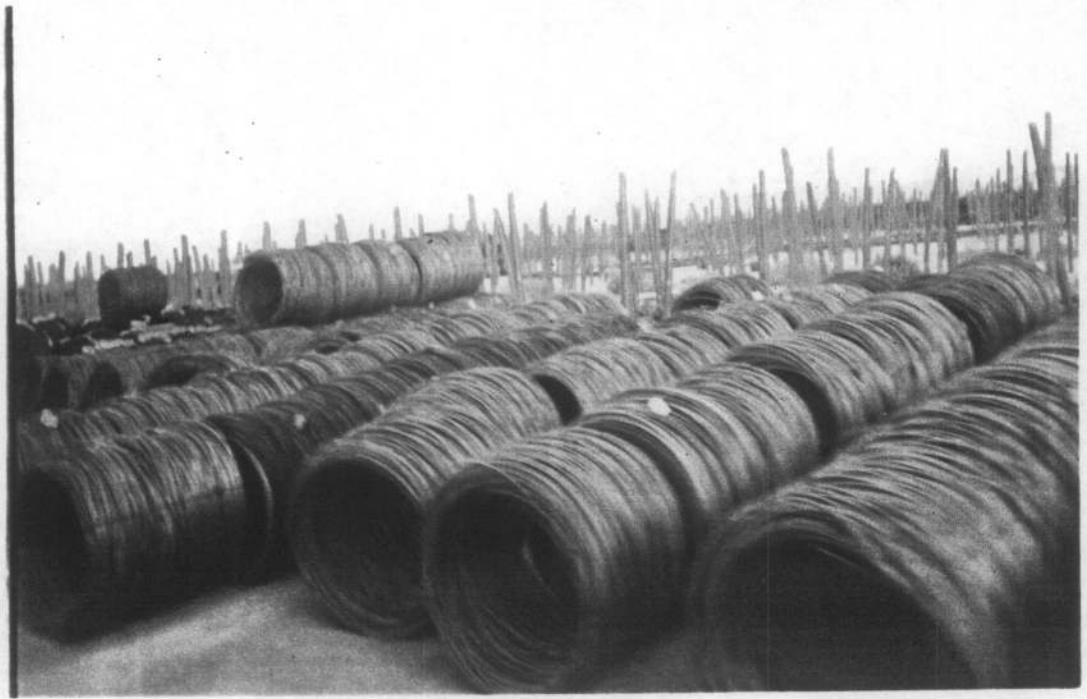
Planche 3 : Couronnes de fer rond à béton (1,6 m de hauteur, 1,25 m de diamètre et 1,3 t. de poids) usinées par le laminoir de la SONASID près d'Arroui (Cliché GUITOUNI - 1992)
