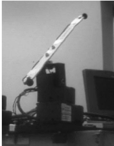
FIGURE 3.2 – Unité pan-tilt équipée de deux microphones omnidirectionnels exploitant la méthode de localisation multiposés, pionnière en audition active (Reid & Milios, 2003).
