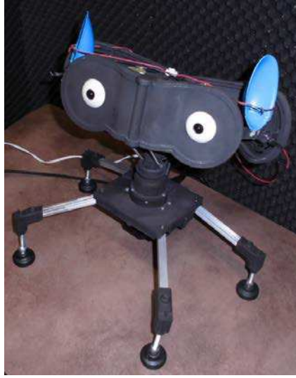
FIGURE 6.2 – La plateforme robotique Binnobot développée par la société BVS et équipée du système auditif périphérique de Psikharpax. Le robot est également équipé de deux caméras mobiles (non utilisées ici). En arrière-plan, un aperçu de la chambre sourde utilisée pour l'expérience. D'après Garcia (2013).
