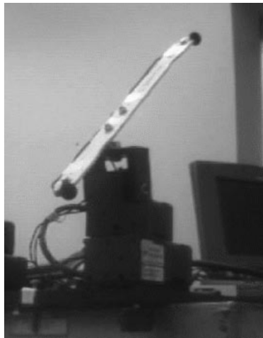
FIGURE 3.2 – Unité pan-tilt équipée de deux microphones omnidirectionnels exploitant la méthode de localisation multiposes, pionnière en audition active (Reid & Milios, 2003).
