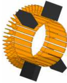
FIGURE A.5 – Le système balais-collecteur du démarreur FS18 .
