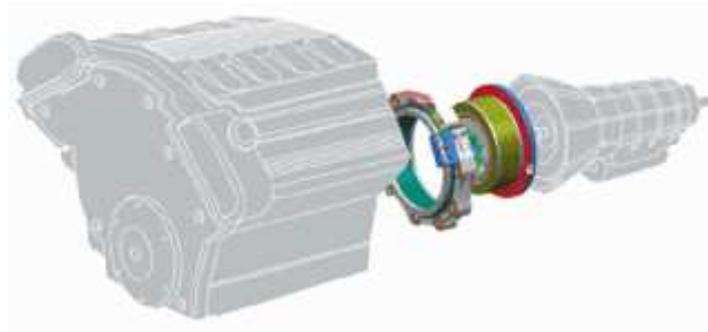
FIGURE 1.7 – Emplacement de l'alternodémarrateurs intégrés.
