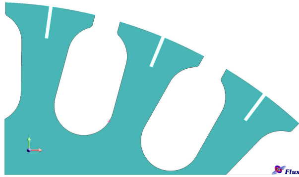
FIGURE 4.5 – Des rainures usinées dans les dents de l'induit.
