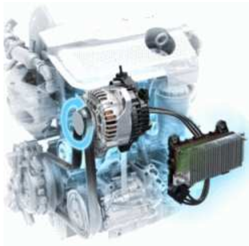
FIGURE 1.6 – Emplacement de l'alternodémarreurs entraîné par courroie.
