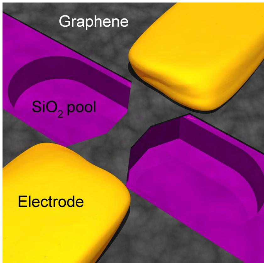
**Figure 5.1.** Schéma représentant du graphène déposé sur un substrat Si/SiO<sub>2</sub> contacté par des électrodes et gravé en forme de nanoruban par EBIE.
