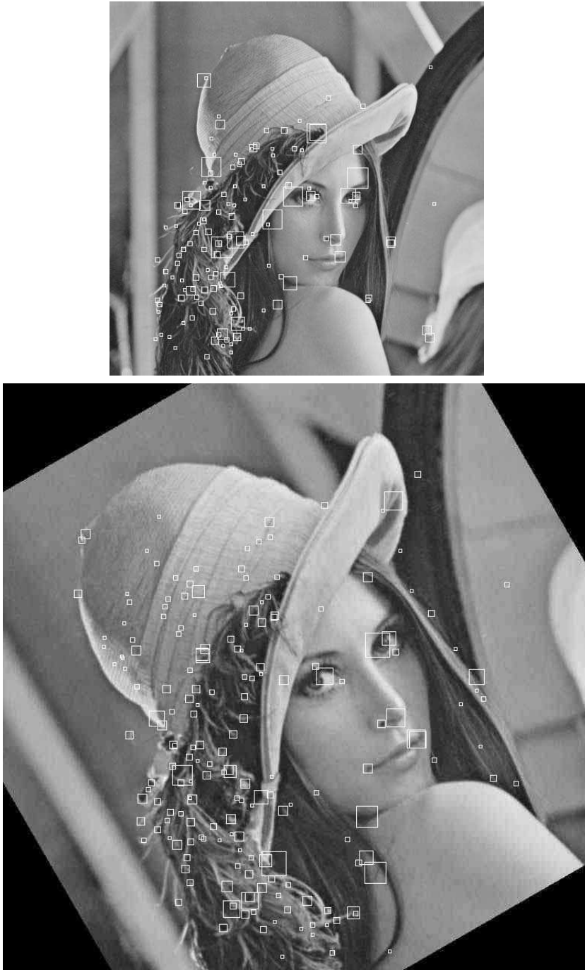
FIG. 1.6 – Visualisation d’une copie composée d’une dilatation de facteur 1.6, d’une rotation d’angle 30 degrés, d’un crop de facteur 30%, et d’une compression JPEG de facteur 10. Les carrés ont leur centre en les points extraits par le détecteur de Harris-Laplace, et leur coté de taille proportionnelle à l’échelle du point extrait.
