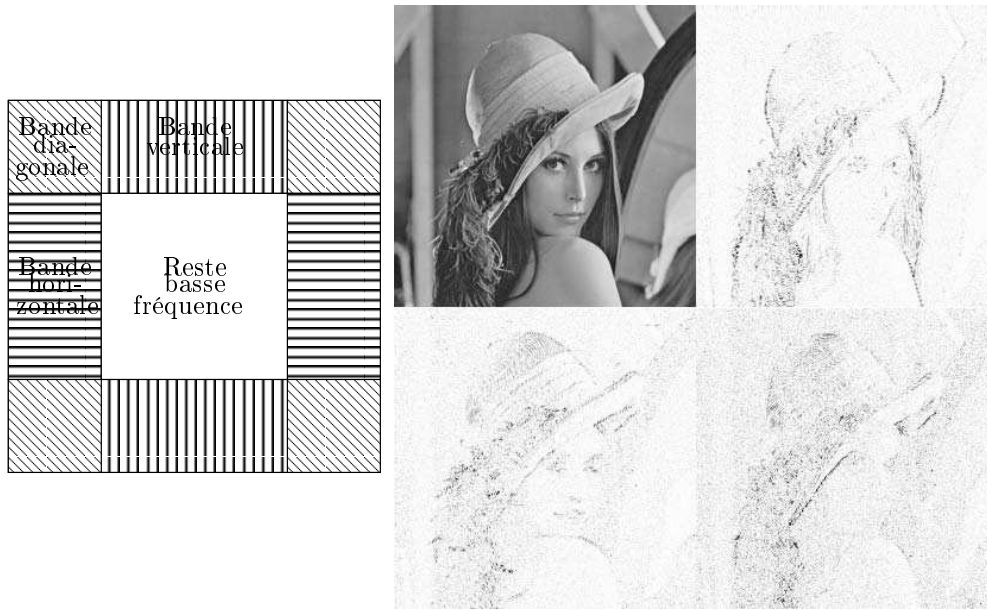
FIG. 3.6 – Figure de gauche : partition du plan espace-fréquence opérée par la transformée discrète en ondelettes séparables. Figure de droite : visualisation sur niveaux de gris normalisés de la valeur absolue des coefficients d’ondelettes séparables sur grille dyadique.
