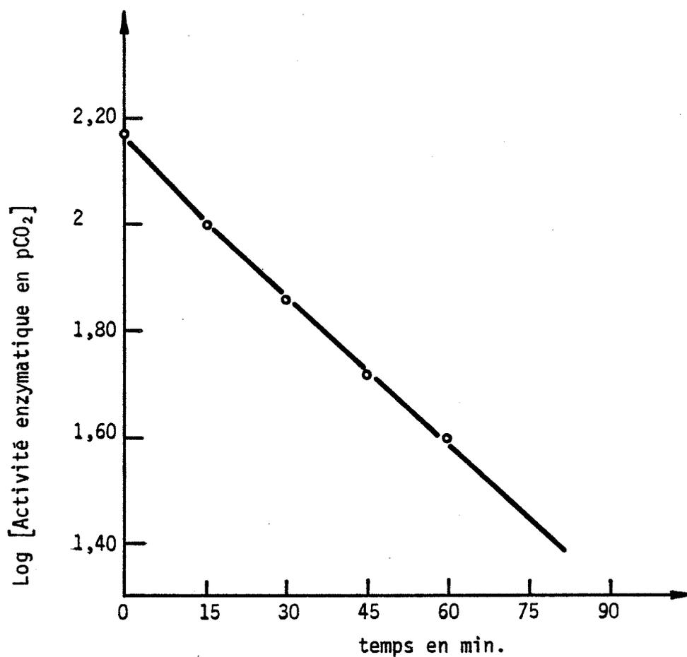
Figure 32 - Evolution de l'activité enzymatique d'une membrane d'uréase (10,5 unités immobilisées) inhibée avec des solutions d' $\text{HgCl}_2$   $10^{-7}\text{M}$  en fonction du temps d'incubation pH = 7,2.
