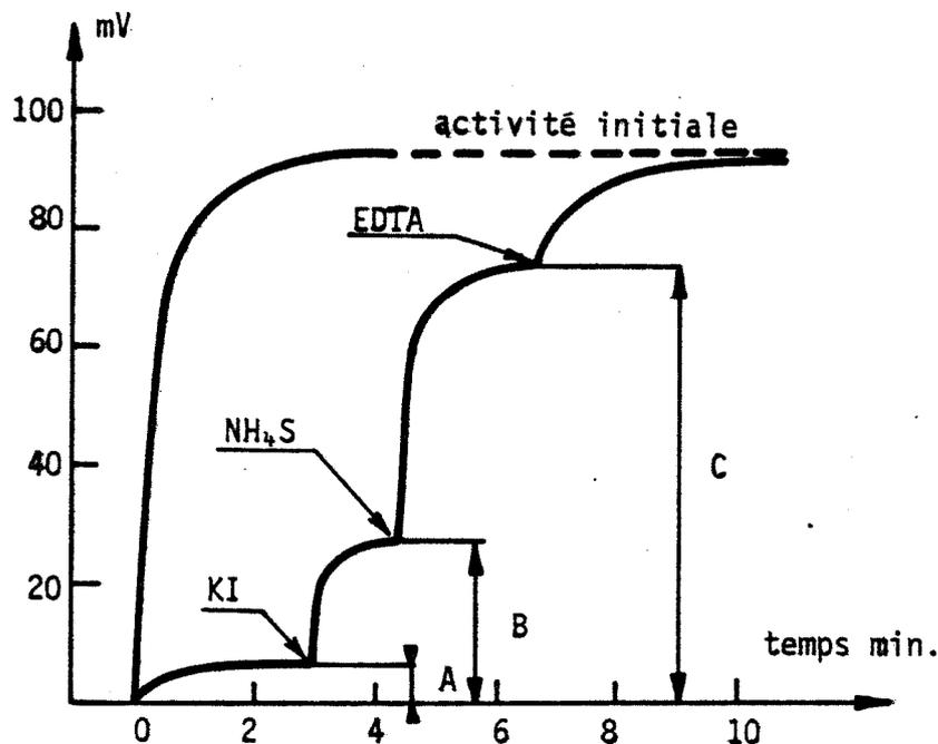
Figure 71 - Réponse du capteur à uréase après régénérations successives de la membrane inhibée par un mélange de 3 ions  $\text{Co}^{2+} 10^{-6}\text{M}$ ,  $\text{Ag}^+ 10^{-6}\text{M}$   $\text{Hg}^{2+} 5 \cdot 10^{-7}\text{M}$  - temps d'incubation : 15 min - membrane 17 UI.
