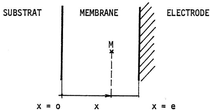
Pour chaque valeur de  $x$  dans la membrane, la variation de la concentration du substrat en fonction du temps est liée à un terme de réaction et un terme de diffusion.
