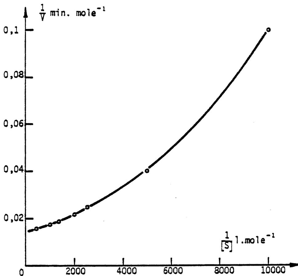
Figure 58 - Représentation de Lineweaver Burk de l'inverse de la vitesse en fonction de l'inverse de la concentration en substrat pour la cholinestérase fixée sur une membrane.
