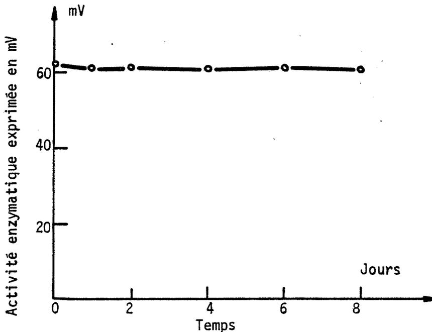
Figure 5 - Réponse d'une électrode à AChE vis-à-vis de l'acétylcholine  $10^{-2}M$  en fonction du temps de séjour dans des solutions tampon phosphate  $^{32}P$  pH = 7,4 de 2 mCi (activité spécifique 0,4 mCi/ml).
