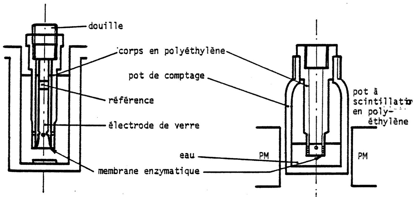
Montage de l'électrode de verre dans le tube porte membrane pour la mesure de l'activité enzymatique
