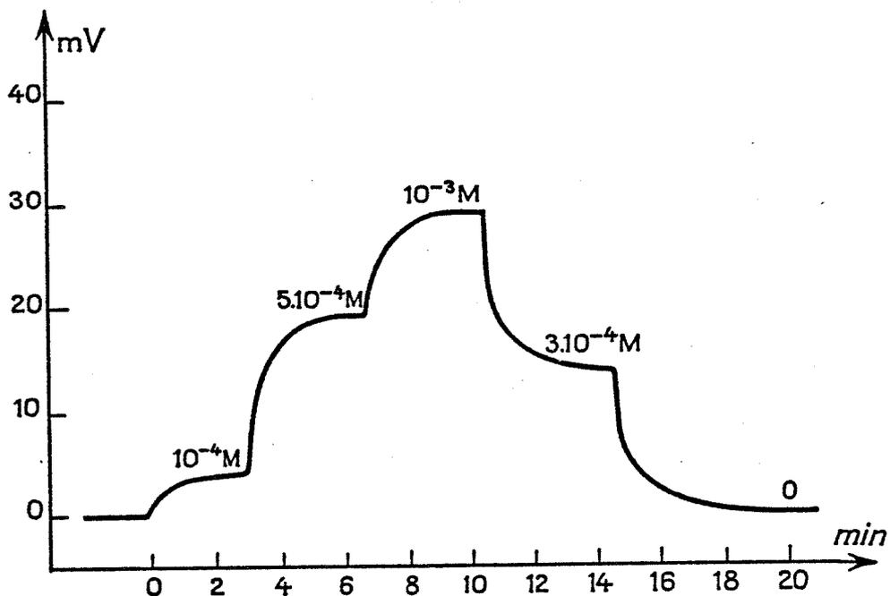
Figure 12 - Réponse de l'électrode à acétylcholinestérase en fonction du temps pour différentes concentrations en acétylcholine (moles/l) à 25°C dans un tampon phosphate 0,01M, pH = 8.
