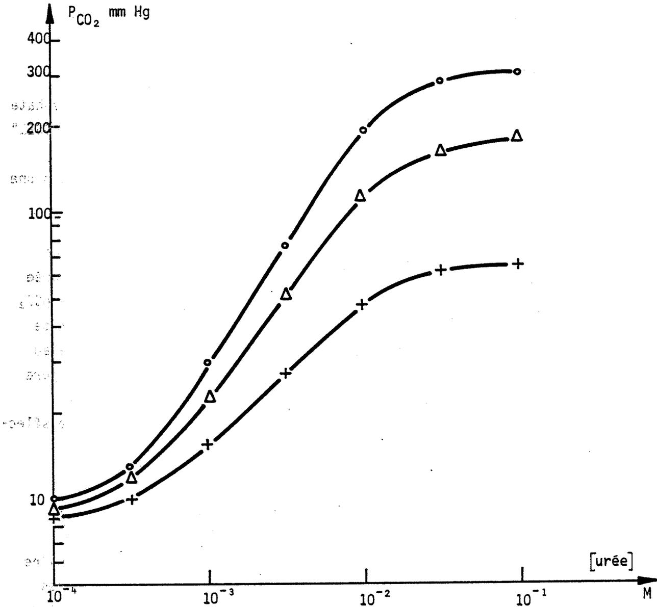
Figure 11 - Réponse de l'électrode à uréase en fonction de la concentration en urée pour différentes concentrations d'uréase fixée dans la couche active.
