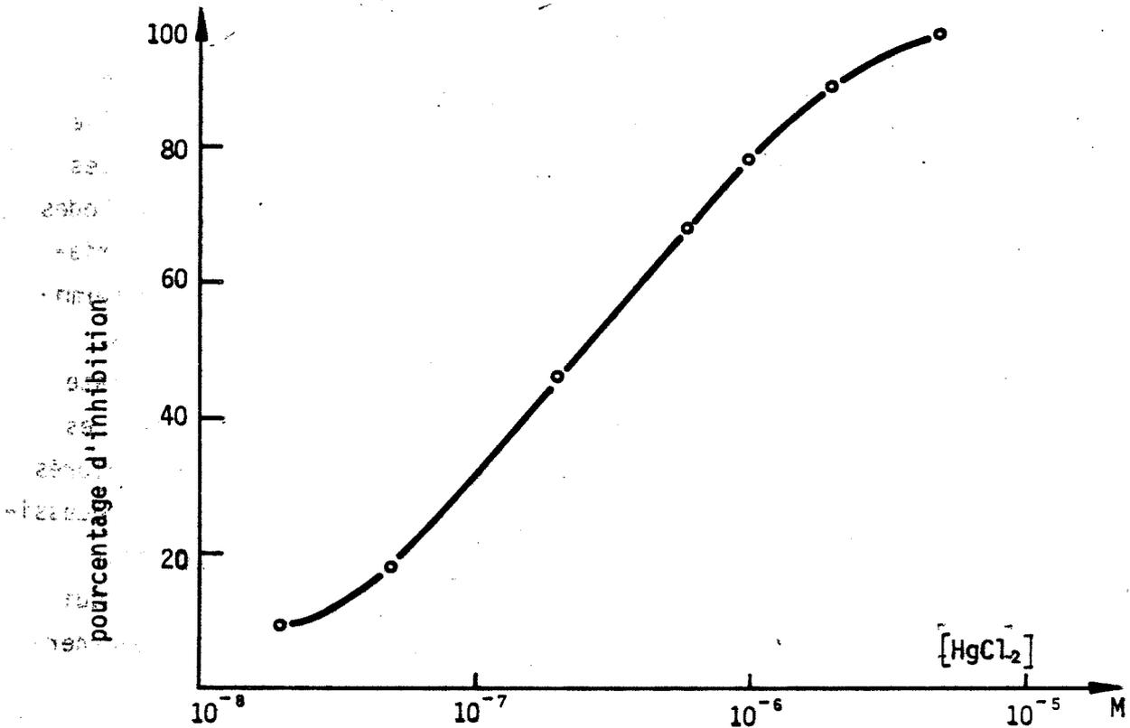
Figure 68 - Courbe de dosage de Hg<sup>2+</sup> à l'aide d'une électrode à uréase de 10 unités fixées sur la membrane, pour un temps d'incubation 15 min. tampon pH = 7
