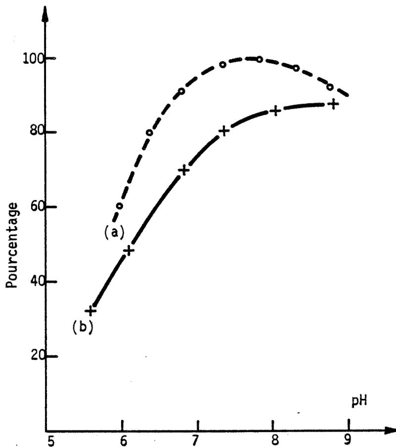
Figure 55 - Comparaison du pourcentage d'inhibition et du pourcentage de régénération en fonction du pH
