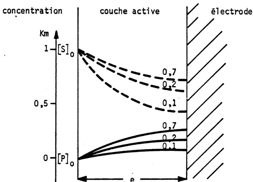
**Figure 60** - Evolution calculée des profils de concentration du substrat (-----) et du produit (——) dans une couche active fixée sur une électrode pour une concentration extérieure en substrat égale au  $K_m$  caractéristique de la membrane :
