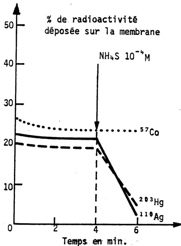
Fixation d'un mélange de 3 ions (<sup>57</sup>Co<sup>2+</sup>, <sup>203</sup>Hg<sup>2+</sup>, <sup>110</sup>Ag<sup>+</sup>) sur des membranes d'uréase.
