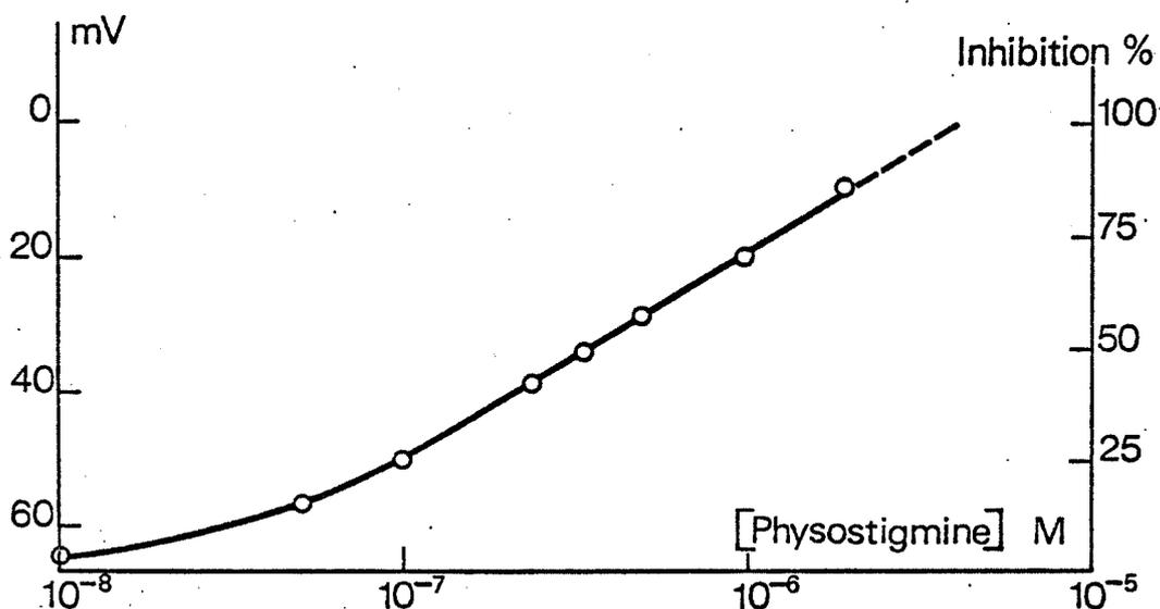
Figure 22 - Variation du potentiel de l'électrode à AChE en fonction des concentrations (moles/l) de physostigmine en milieu chlorure d'acétylcholine 10<sup>-2</sup>M à pH = 6,8.
