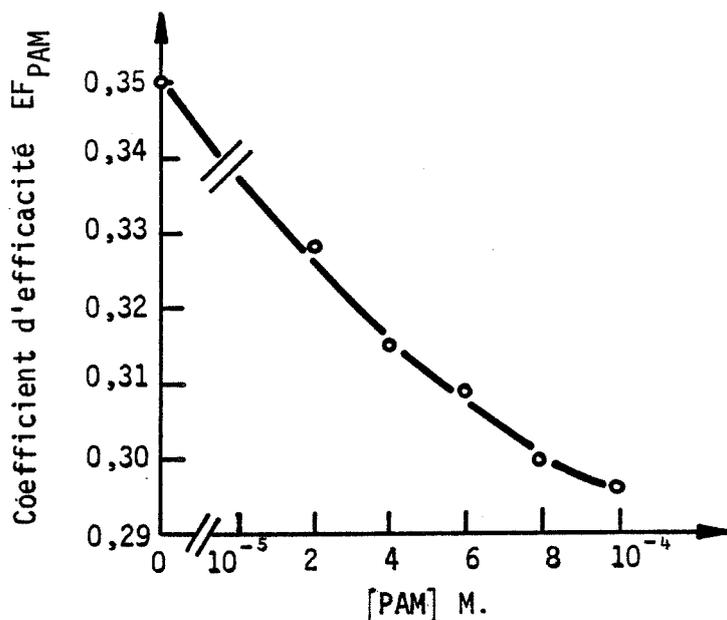
Figure 11 - Courbe de correction de quenching couleur dans la PAM. Evolution du facteur d'efficacité de comptage du  $^{32}P$  par effet Cerenkov en solution en fonction de la concentration des solutions aqueuses de PAM par la méthode de l'étalon interne.
