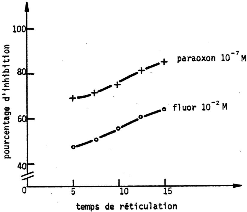
**Figure 67** - Variation du pourcentage d'inhibition des membranes d'AChE réticulées suivant des temps variables soumise à des solutions de paraoxon  $10^{-7}$  M ( + — + — + — ) et de fluor ( — o — o — )  $\cdot 10^{-2}$  M
