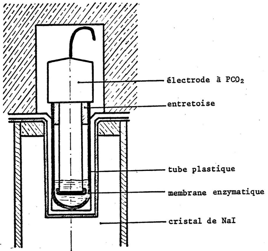
Figure 2 - Géométrie de comptage  $\gamma$  d'une électrode enzymatique
