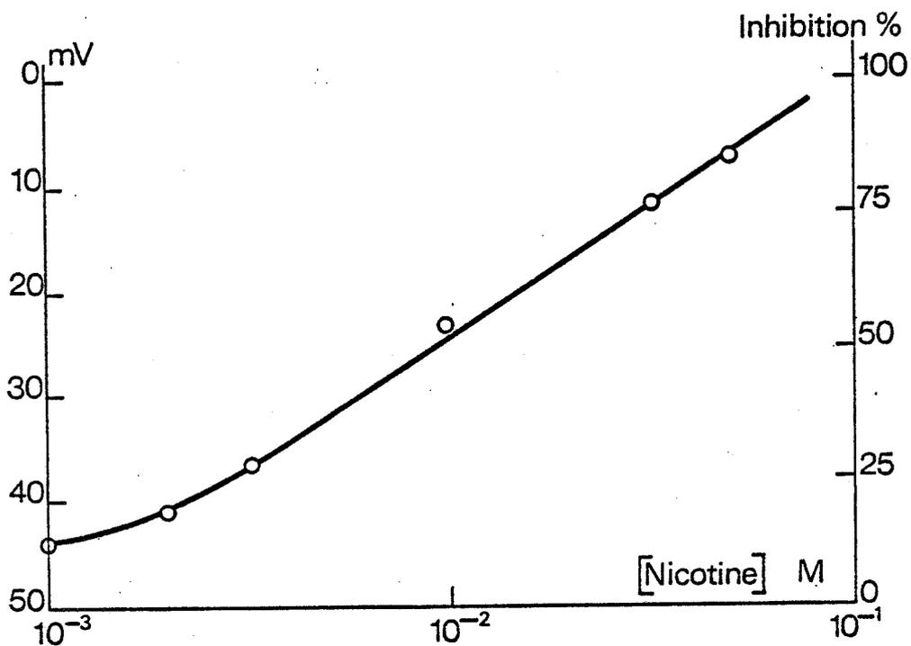
Figure 18 - Variation du potentiel de l'électrode à AChE en fonction des concentrations (moles/l) de nicotine en milieu chlorure d'acétylcholine 10<sup>-2</sup>M pH = 7,4.
