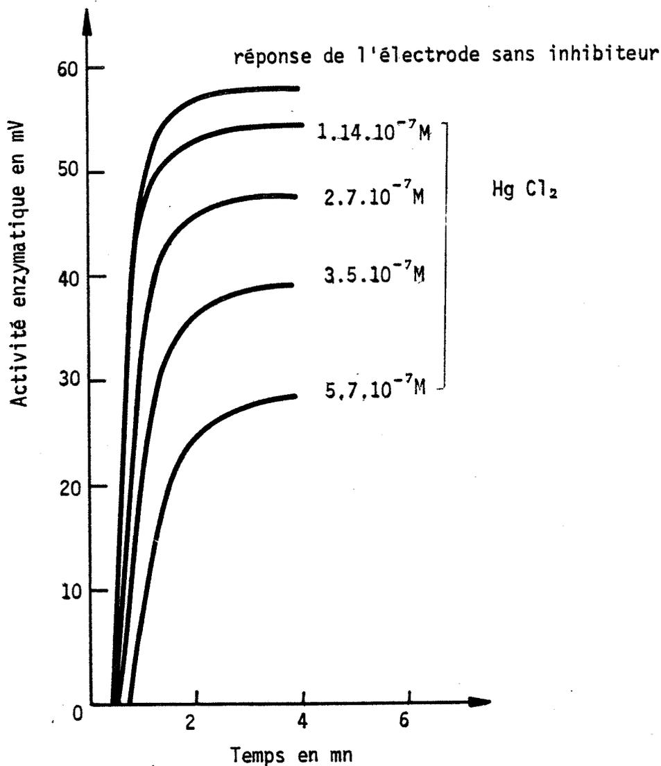
Figure 30 - Réponse d'une électrode d'uréase en fonction du temps pour différentes concentrations en HgCl<sub>2</sub>
