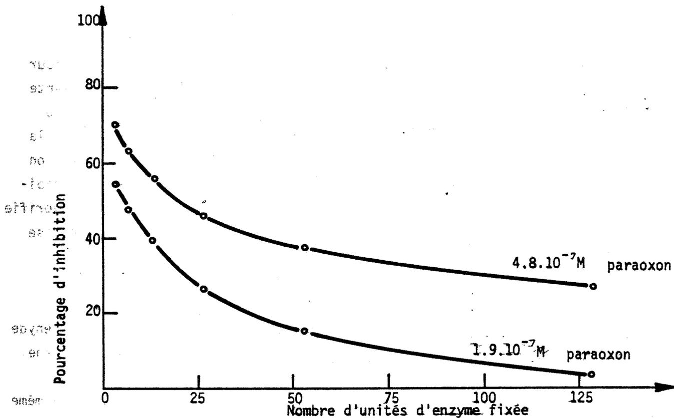
Figure 65 - Variation du pourcentage d'inhibition des électrodes d'AChE en fonction du nombre d'unités d'enzyme fixées sur la membrane vis-à-vis de solution de paraoxon ( $4,8 \cdot 10^{-7}\text{M}$  et  $1,9 \cdot 10^{-7}\text{M}$ ).
