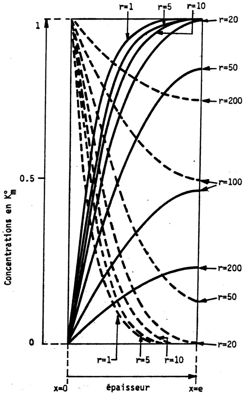
**Figure 61** - Profils de concentration calculés du substrat (-----) et du produit (—) dans une membrane active en fonction des concentrations d'inhibiteur  $[I]$ . Les concentrations de substrat et de produit sont exprimées en  $K_m^o$ ;  $V_m^o = 10^{-5} \text{ mole.cm}^{-3} \text{ s}^{-1}$   $K_m^o = 10^{-5} \text{ mole.cm}^{-3}$
