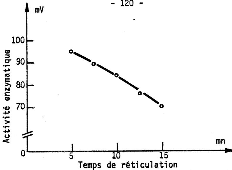
**Figure 66** - Variation de l'activité enzymatique d'une électrode d'AChE en fonction du temps de réticulation.
