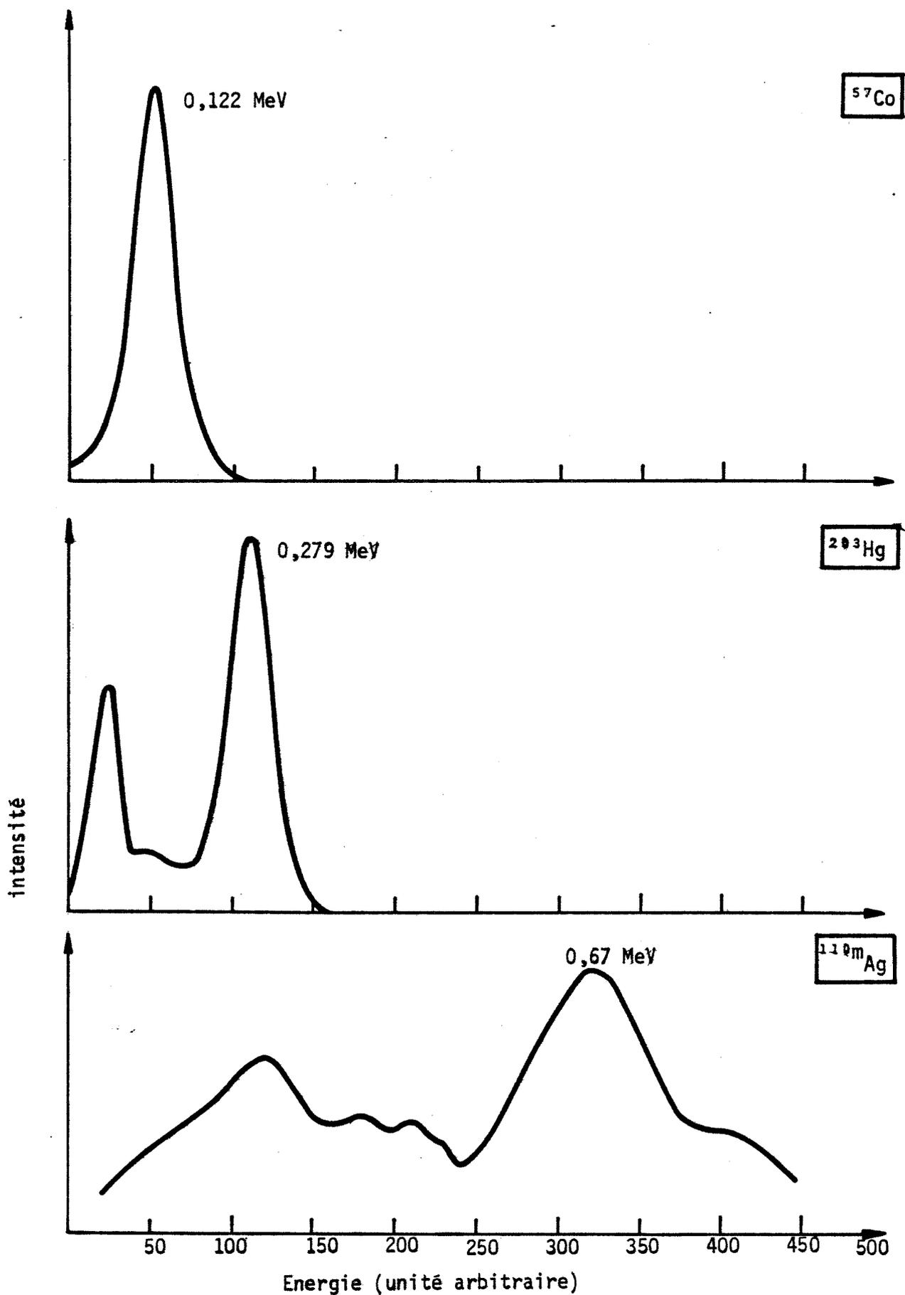
Figure 3 - Spectrogrammes des radioéléments  $^{57}\text{Co}$   $^{203}\text{Hg}$   $^{110\text{m}}\text{Ag}$
