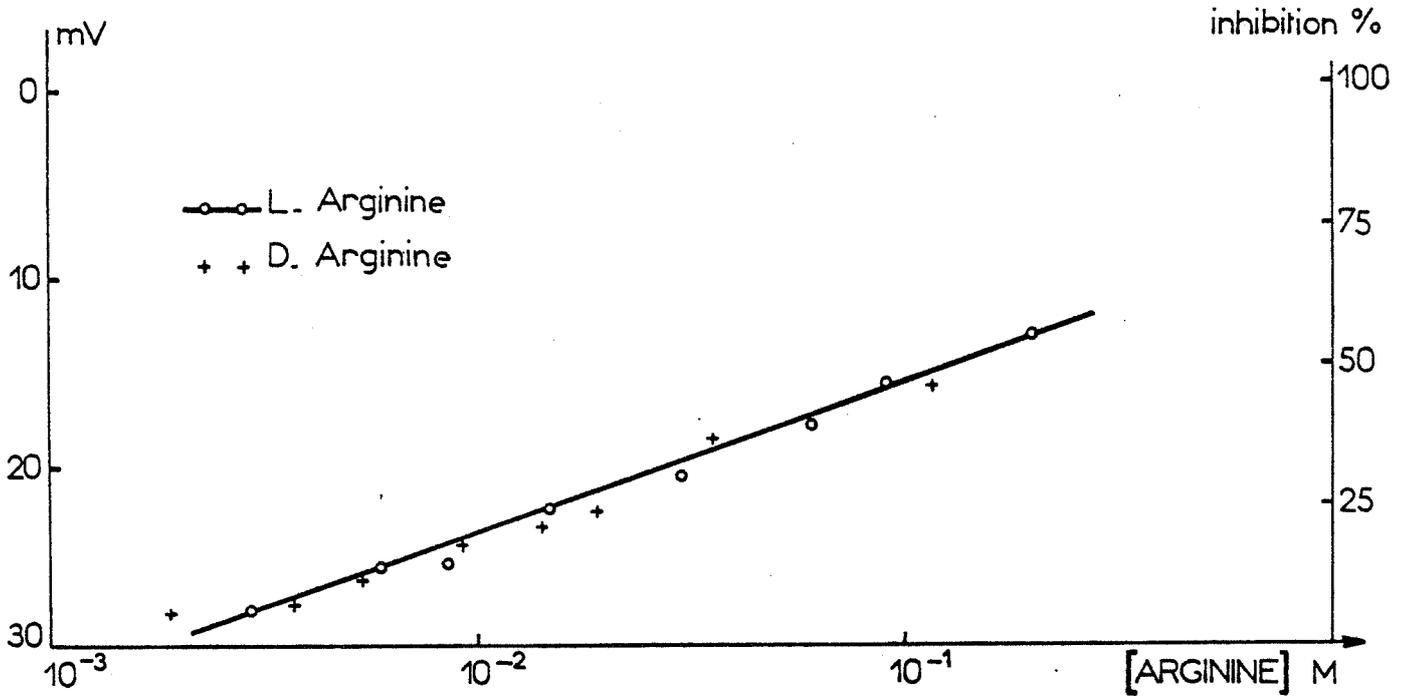
Figure 19 - Variation du potentiel de l'électrode à AChE en fonction des concentrations (mole/l) d'arginine en milieu chlorure d'acétylcholine 10<sup>-2</sup>M à pH 7,2.
