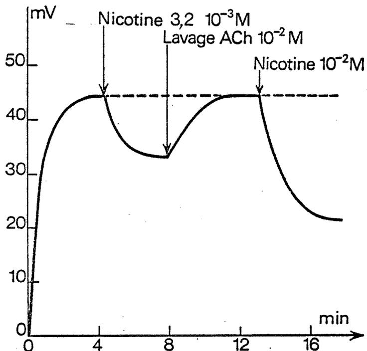
Figure 17 - Réponse de l'électrode à AChE en milieu chlorure d'acétylcholine 10<sup>-2</sup>M, pH = 7,4 vis-à-vis de différentes concentrations en nicotine.
