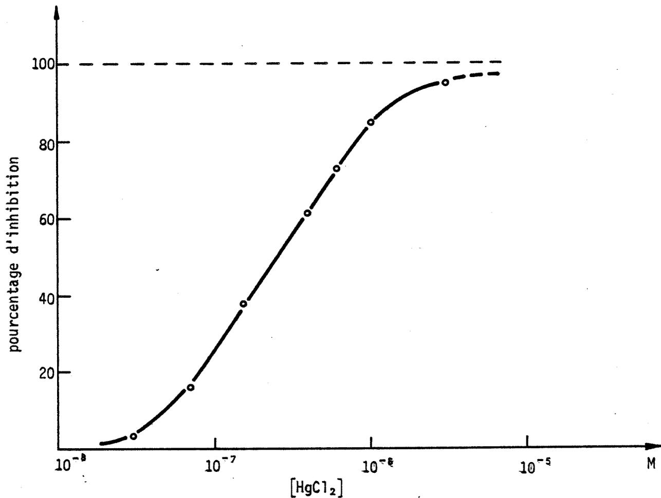
**Figure 31** - Variation du % d'inhibition d'une membrane d'uréase en fonction de la concentration: d' $\text{HgCl}_2$  (mole/l) pour un temps d'incubation de 10 min. à pH = 7,2.
