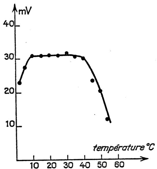
Figure 15 - Réponse de l'électrode à acétylcholine en fonction de la température pour une concentration d'acétylcholine de  $10^{-2}$ M.
