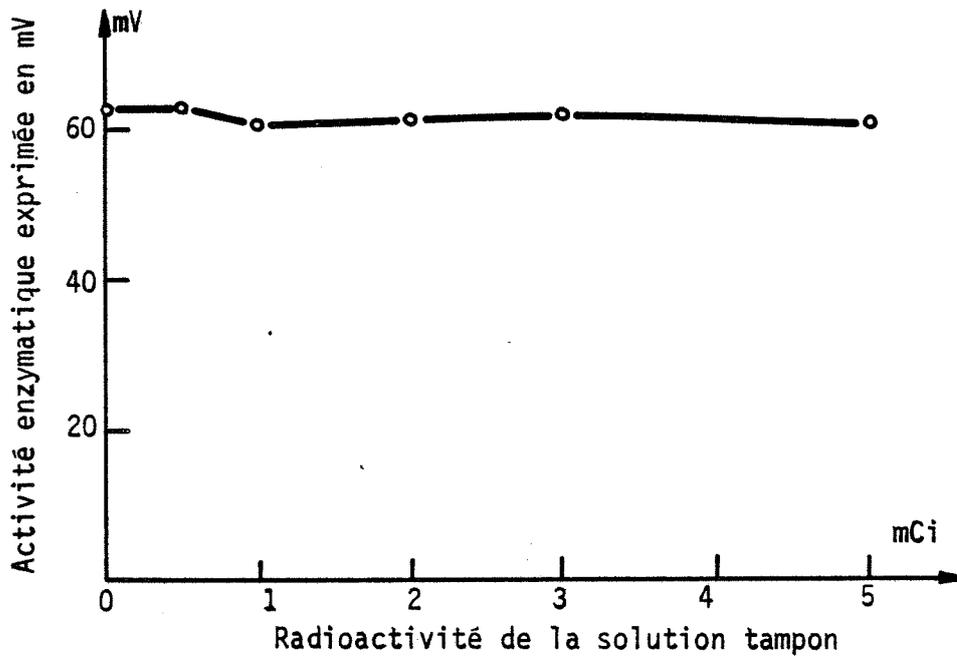
Figure 6 - Contrôle de la réponse vis-à-vis de l'acétylcholine  $10^{-2}M$  d'une électrode à AChE ayant été soumise pendant un jour à des solutions phosphate -  $^{32}P$  de radioactivité variant de 1 à 5 mCi.
