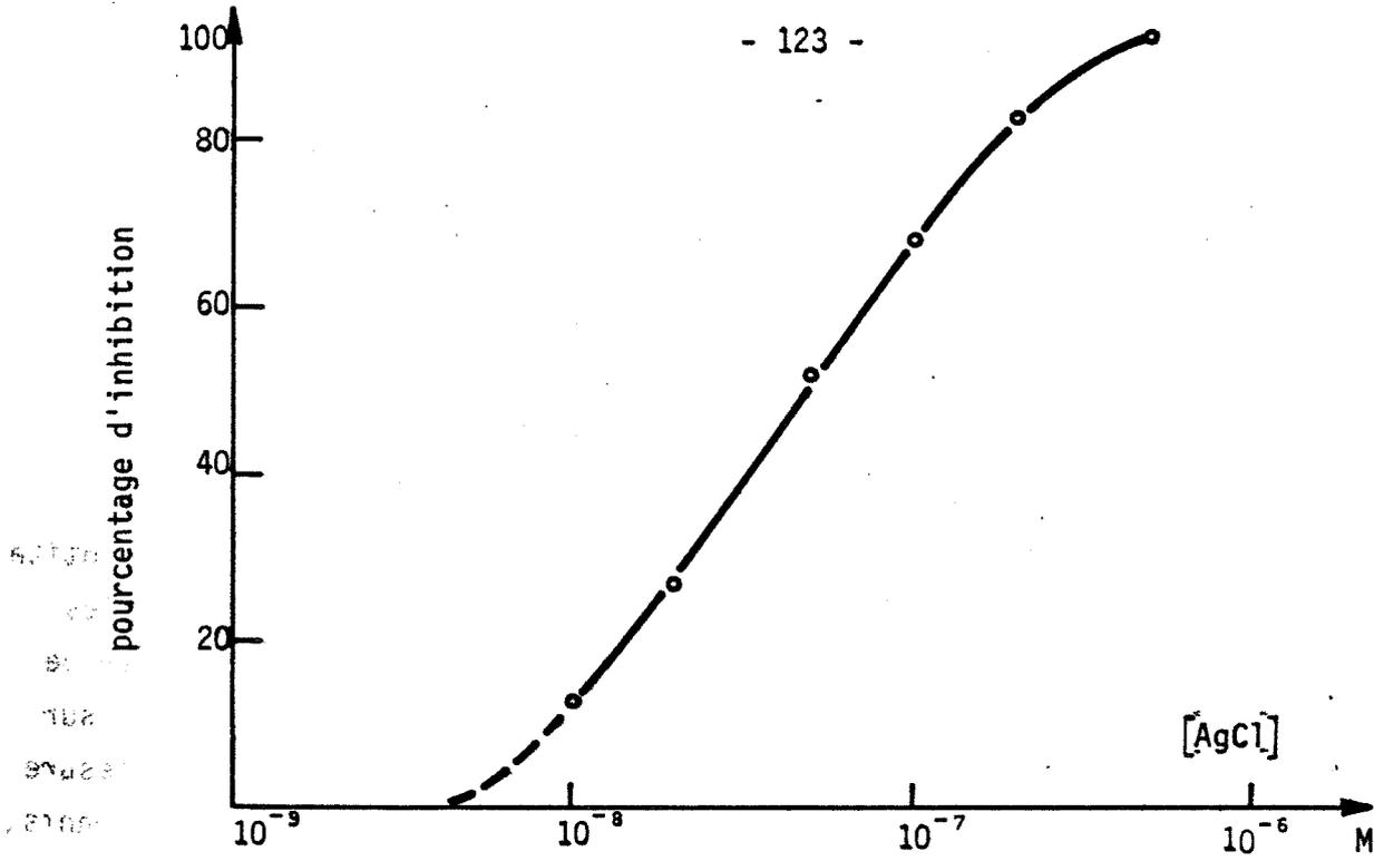
Figure 67 - Courbe de dosage de Ag<sup>+</sup> à l'aide d'une électrode à uréase de 4 unités fixées sur la membrane pour un temps d'incubation 30 min. tampon pH = 7,6
