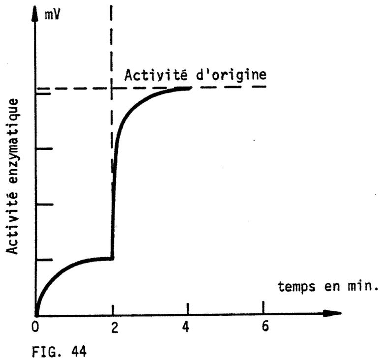
Régénération en continu par KI 10<sup>-2</sup>M d'une électrode enzymatique d'uréase inhibée par l'argent.
