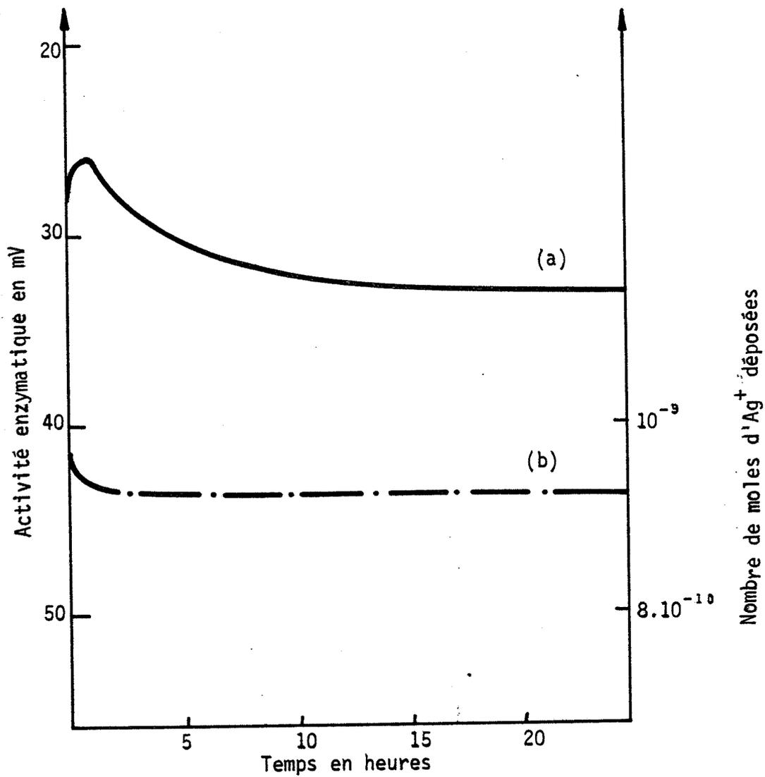
Figure 40 — a) évolution de l'activité enzymatique d'une membrane d'uréase de concentration élevée (15 UI) inhibée au préalable pendant 10 mn avec des ions Ag<sup>+</sup> (10<sup>-9</sup> moles).
