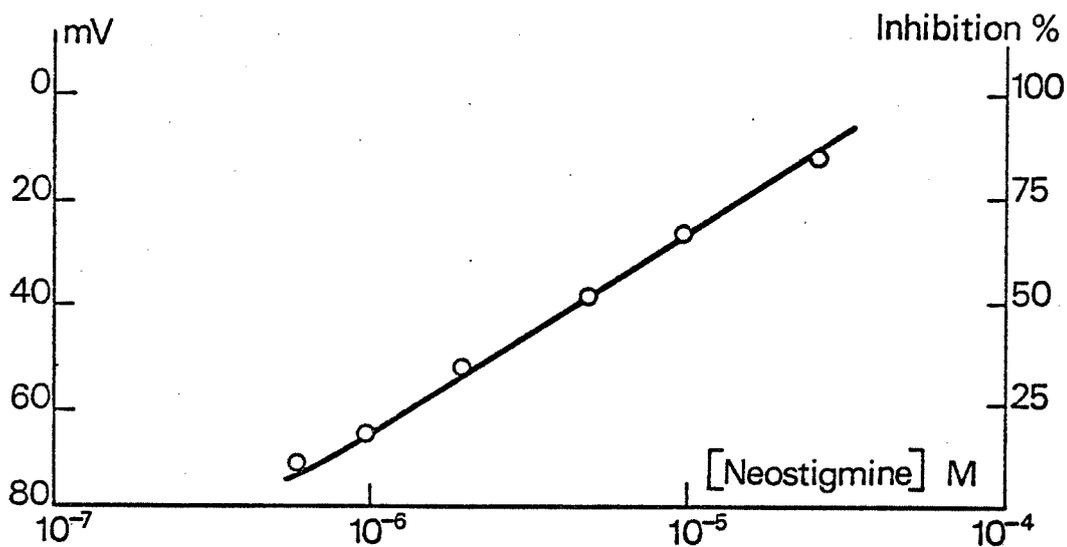
Figure 21 - Variation du potentiel de l'électrode à AChE en fonction des concentrations (moles/l) de néostigmine en milieu chlorure d'acétylcholine 10<sup>-2</sup>M à pH = 8,5.
