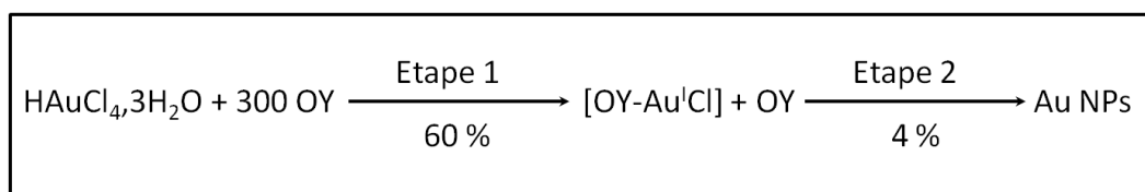
Figure 3-32 : Schéma illustrant les rendements de chacune des étapes de réaction.
