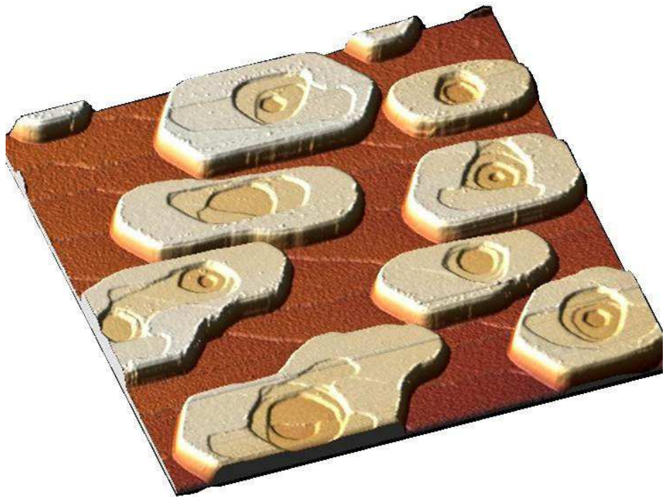
Figure 2.2.1 : Carte topographique. ( 1,06 \times 1,06 \mu\text{m}^2 , 24 \text{ mV} , 0,061 \text{ nA} , échelle z : 0 à 7,3 \text{ nm} ).
