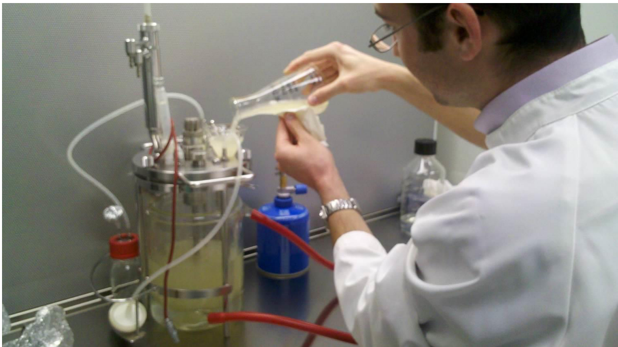
Figure 27 : Ensemencement du bioréacteur, effectué sous hotte à flux laminaire, à l'aide d'un entonnoir stérile
