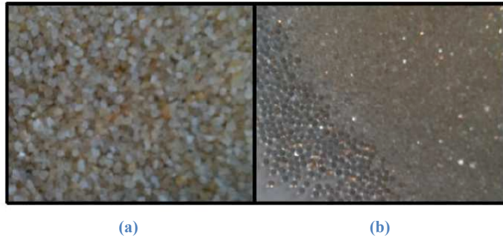
Figure 1.29 : (a) Les sables concassés irréguliers. (b) Les billes de verre sphérique. La taille de grain des sables et les billes de verre compris entre 600 et 800 \mu\text{m} .
