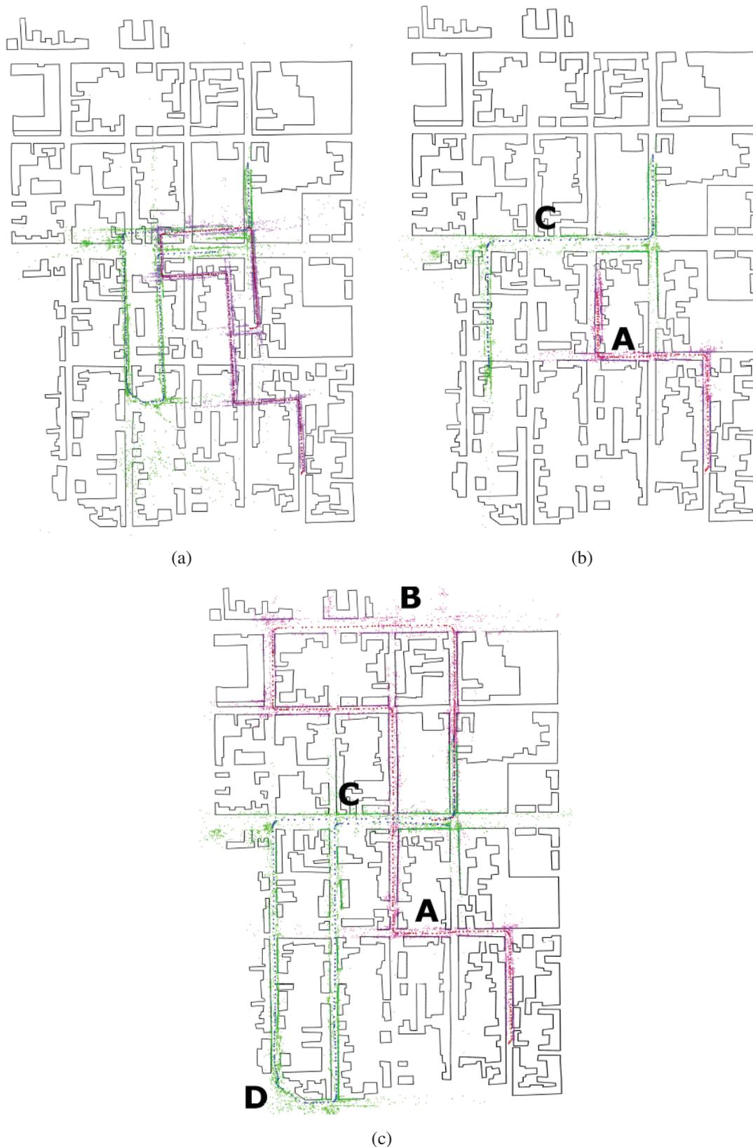
FIGURE 4.14 – Localisation dans un milieu urbain en utilisant un SLAM contraint au MET et aux modèles 3D des bâtiments. (a) Localisation obtenue avec un SLAM classique Mouragnon et al. (2006). (b) Localisation obtenue avec un SLAM contraint uniquement aux modèles 3D des bâtiments Tamaazousti et al. (2011). (c) Localisation obtenue avec un SLAM contraint à un modèle SIG complet.
