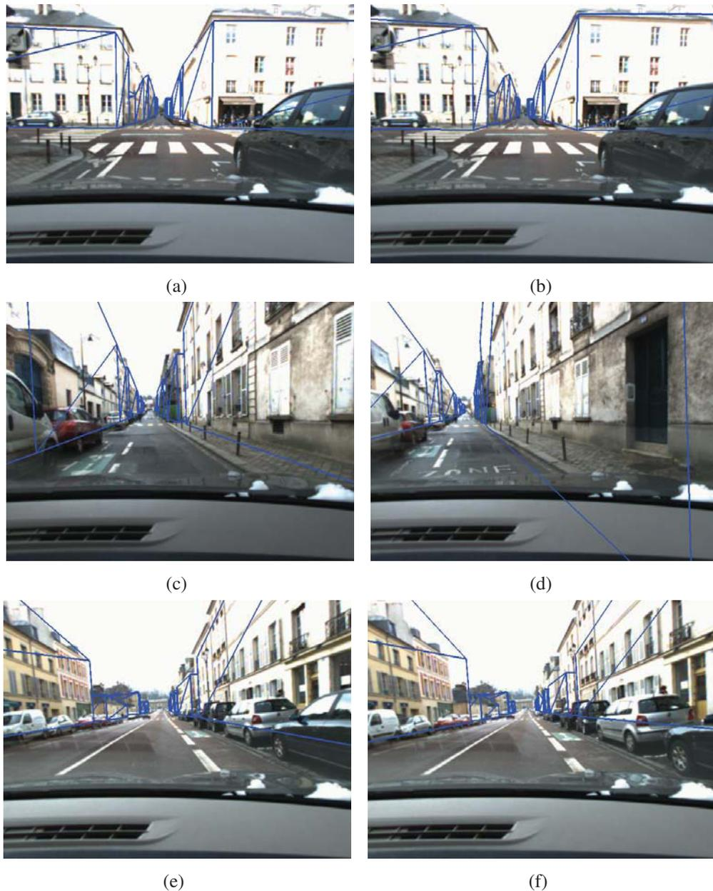
FIGURE 7.11 – Exemples de re-projection des modèles des bâtiments sur des images extraites de la séquence de Versailles. La colonne de gauche représente le résultat en utilisant notre processus de correction du biais. La colonne de droite représente le résultat obtenu par le SLAM contraint aux données GPS brutes et au MET. Les erreurs de re-projection associées : (a) 8.32 pixels, (b) 16.79 pixels, (c) 5.74 pixels, (d) 16.50 pixels, (e) 6.15 pixels et (f) 24.10 pixels.
