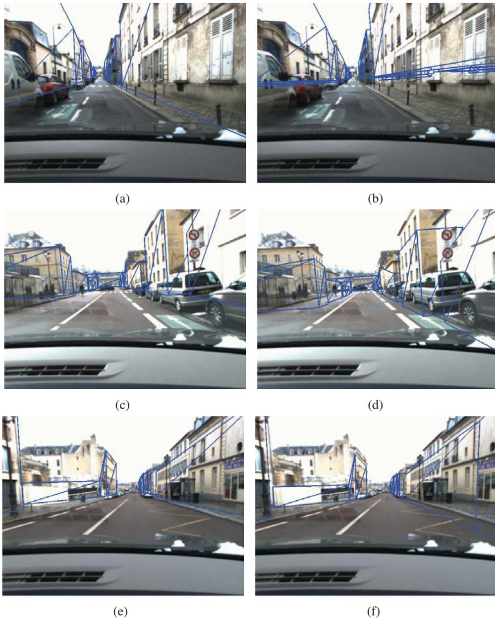
FIGURE 6.8 – Exemples de re-projection des modèles des bâtiments sur des images extraites de la première séquence de Versailles. La colonne de gauche représente le résultat de la méthode proposée. La colonne de droite représente le résultat obtenu avec la méthode introduite par Lothe et al. (2009). Les erreurs de re-projections associées sont : (a) 8.23 pixels, (b) 37.66 pixels, (c) 6.50 pixels, (d) 13.95 pixels (e) 6.24 pixels and (f) 7.19 pixels.
