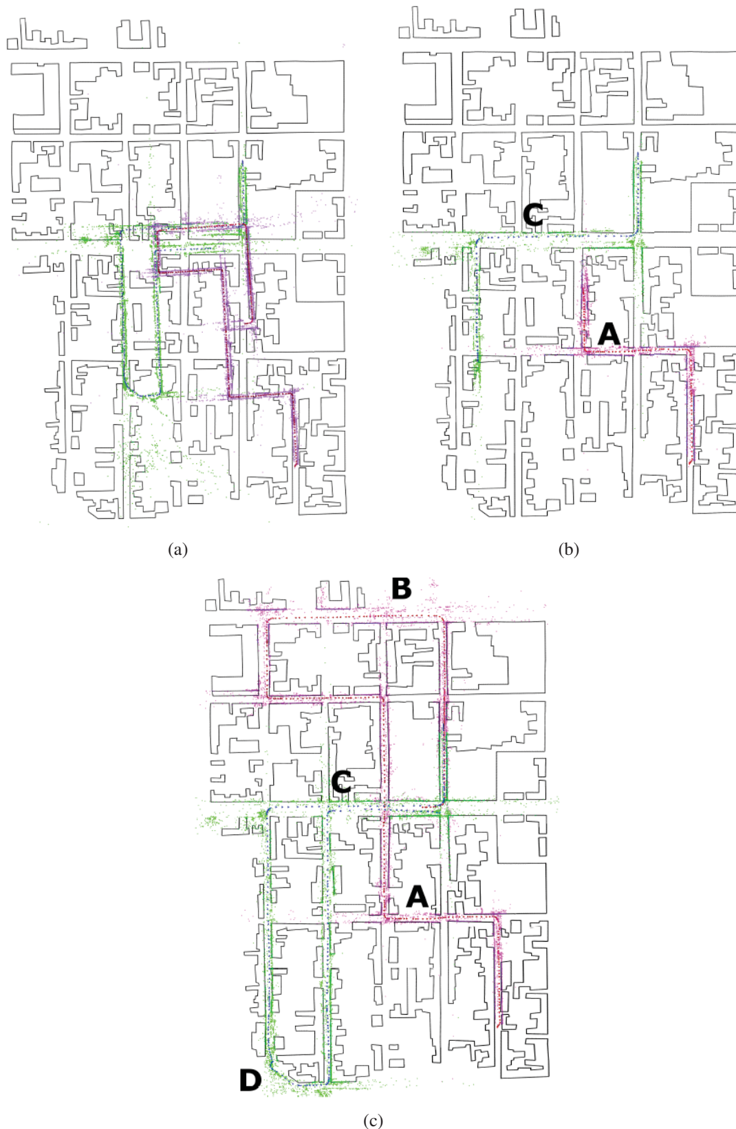
FIGURE 4.14 – Localisation dans un milieu urbain en utilisant un SLAM contraint au MET et aux modèles 3D des bâtiments. (a) Localisation obtenue avec un SLAM classique Mouragnon et al. (2006). (b) Localisation obtenue avec un SLAM contraint uniquement aux modèles 3D des bâtiments Tamaazousti et al. (2011). (c) Localisation obtenue avec un SLAM contraint à un modèle SIG complet.
