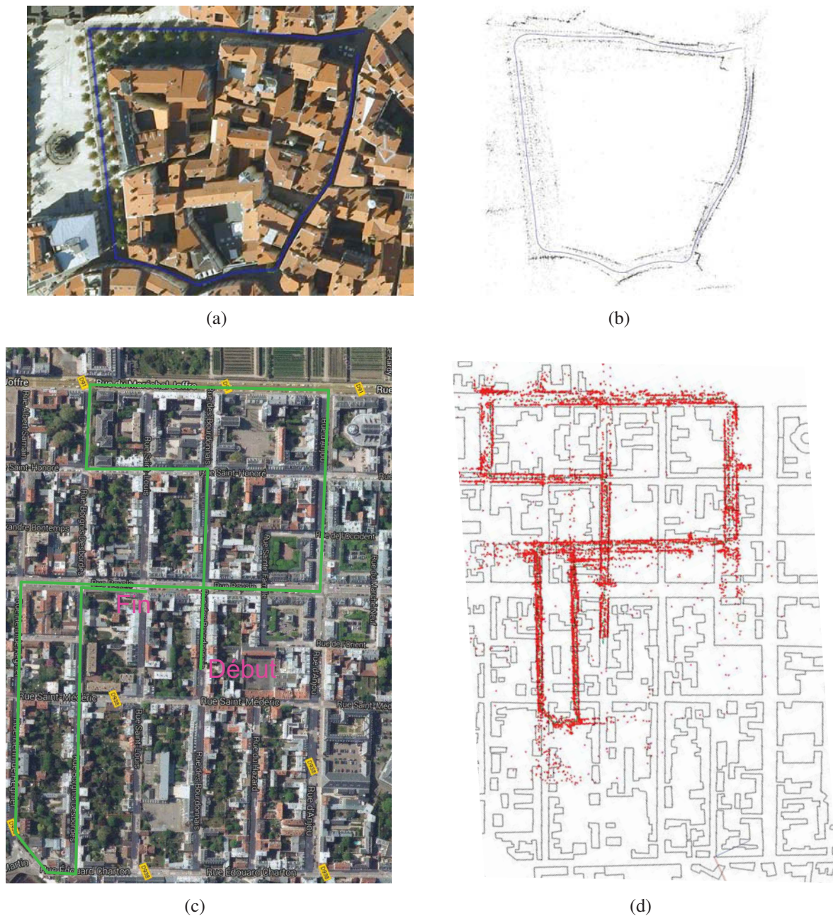
FIGURE 1.11 – Reconstructions SLAM. Exemples de reconstructions obtenues avec la méthode de Mouragnon et al. (2006) sur une distance de 400 mètres (a,b) et sur une distance de 1.5 kilomètres (c,d).
