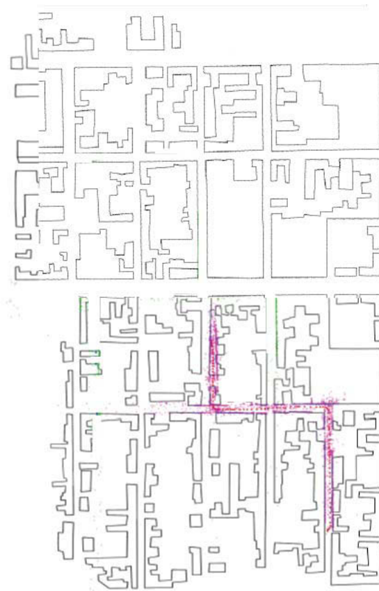
FIGURE 3.7 – Résultat de la localisation en ligne obtenue avec l'approche de Tamaazousti et al. (2011) . Pour la séquence utilisée, la solution échoue.
