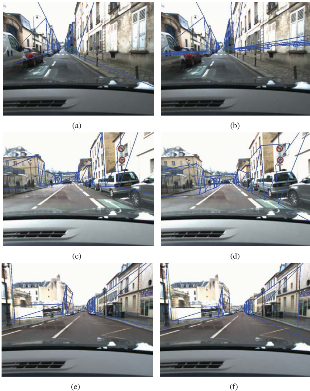
FIGURE 6.8 – Exemples de re-projection des modèles des bâtiments sur des images extraites de la première séquence de Versailles. La colonne de gauche représente le résultat de la méthode proposée. La colonne de droite représente le résultat obtenu avec la méthode introduite par Lothe et al. (2009). Les erreurs de re-projections associées sont : (a) 8.23 pixels, (b) 37.66 pixels, (c) 6.50 pixels, (d) 13.95 pixels (e) 6.24 pixels and (f) 7.19 pixels.
