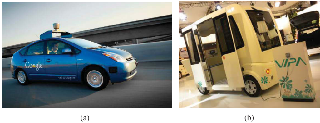
FIGURE 1 – Exemples de voitures autonomes. (a) Véhicule développée par Google, (b) Véhicule VIPA développée par l’Institut Pascal.
