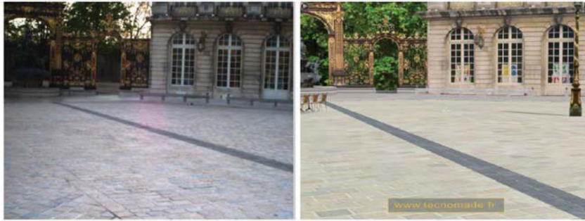
FIGURE 2.4 – Localisation basée vision exploitant des modèles 3D texturés. Il est possible de mettre en correspondance l'image courante (à gauche) avec une image de synthèse générée à partir du SIG (à droite) ( extrait de Cappelle et al. (2010) ).
