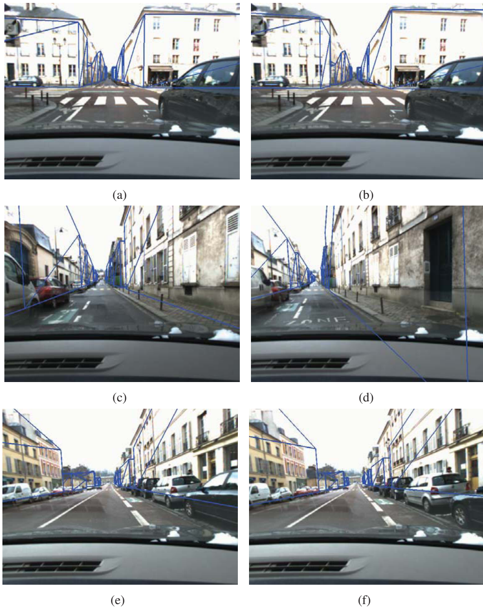
FIGURE 7.11 – Exemples de re-projection des modèles des bâtiments sur des images extraites de la séquence de Versailles. La colonne de gauche représente le résultat en utilisant notre processus de correction du biais. La colonne de droite représente le résultat obtenu par le SLAM contraint aux données GPS brutes et au MET. Les erreurs de re-projection associées : (a) 8.32 pixels, (b) 16.79 pixels, (c) 5.74 pixels, (d) 16.50 pixels, (e) 6.15 pixels et (f) 24.10 pixels.
