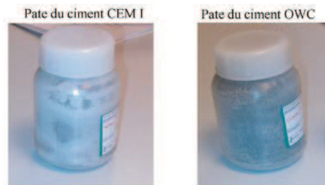
Fig. 4.3. Photographie des deux pates de ciments. A gauche le ciment portland ordinaire (CEM I), à droite le ciment de classe G (OWC).
