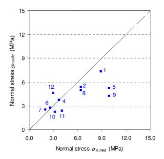
Figure 8 : Comparaison des magnitudes des contraintes normales obtenues par la technique utilisant les petits vérins plats ( $\sigma_{n,mes}$ ) et avec le modèle FLAC3D ( $\sigma_{n,calc}$ ), avec  $\nu = 0,47$ , en considérant uniquement les effets gravitaires.
