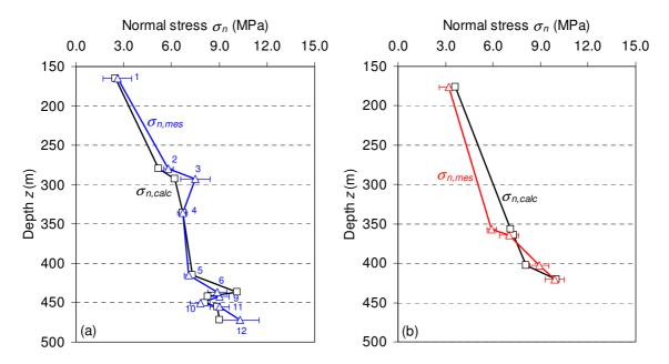
Figure 7 : Variation en fonction de la profondeur de la magnitude de la contrainte normale telle que mesurée par les tests hydrauliques ( $\sigma_{n,mes}$ ) et générée par le modèle FLAC3D avec  $\nu$  = 0,47, en ne tenant compte que de la gravité, dans les puits de forage (a) PD19 et (b) PD23.
