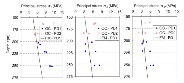
Figure 9 : Variation, en fonction de la profondeur, de la magnitude des contraintes principales ( $\sigma_l$ ,  $\sigma_{ll}$ ,  $\sigma_{ll}$ ) obtenues par les tests de surcarottage (OC) et avec le modèle FLAC3D (FM), avec  $\nu$  = 0,47, en considérant uniquement les effets gravitaires.
