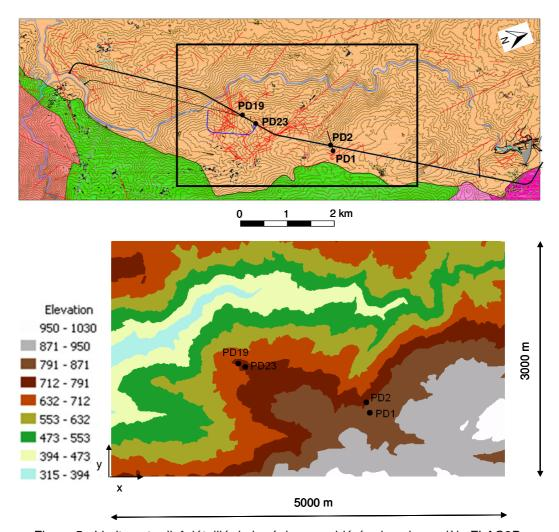
Figure 5 : Limites et relief détaillé de la région considérée dans le modèle FLAC3D.
