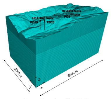
Figure 6 : Trame du modèle FLAC3D.
