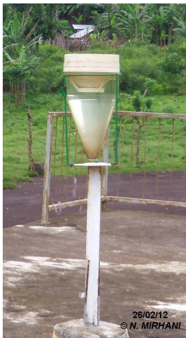
Photo 15- Pluviomètre rempli d'eau pendant des jours sans relevés
