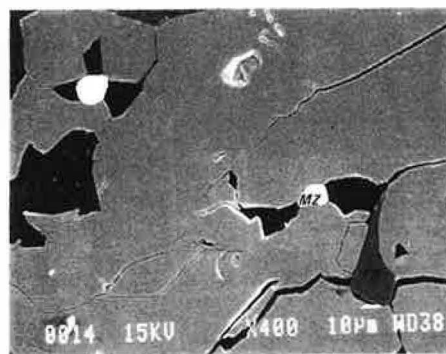
D: Microveines à monazite (MZ) et forstérite (FO). Image MEB électrons secondaires
