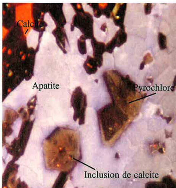
Figure 13C: Cristaux d'apatite de teinte (CL) bleu violacée à mauve dans une pyroxénite. On peut remarquer des cristaux automorphes de pyrochlore faiblement luminescent renfermant des inclusions de calcite (teinte orangée). CL, X20.
