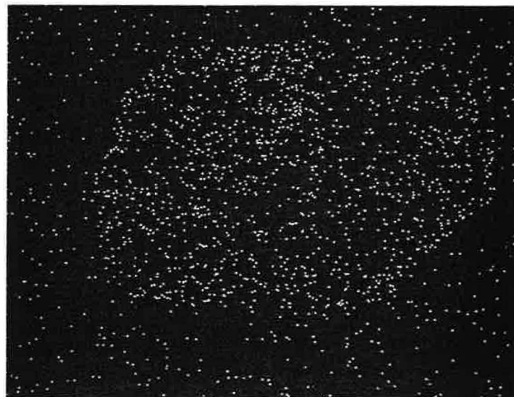
B: Image (X-Ray) caractéristique du La ( L_{\alpha 1} ), X800.
