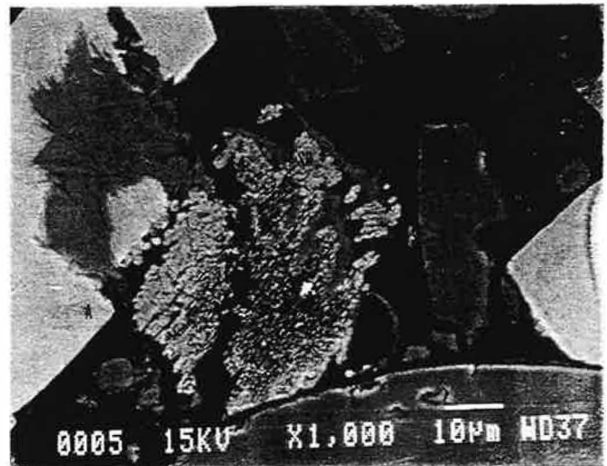
D: Vue montrant le développement de la strontianite (SR) en intercroissance avec le silicate de fer (SF). (MEB-électrons secondaires).
