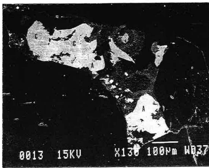
A: Remplissage d'une veine hydrothermale par de l'ancylite (A), de la celestite (C) et de la strontianite (SR), (MEB-électrons secondaires)
