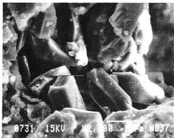
Figure IV-11- D: Détail de la photo précédente montrant les cristaux dentiformes de quartz (MEB électrons secondaires).
