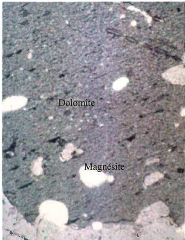
Figure 4B: Inclusion de cristaux subsphériques de magnésite dans un cristal de dolomite primaire (carbonatite à magnésite ). LP, X 10.
