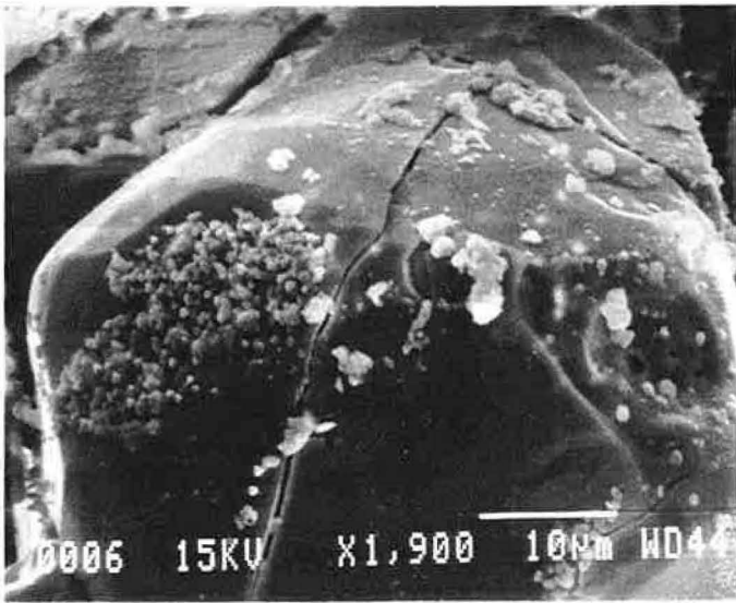
Figure IV-9: A- Développement de la crandallite (nodule) et de la millisite (amygdale) sur un cristal de pyrochlore (MEB électrons secondaires)
