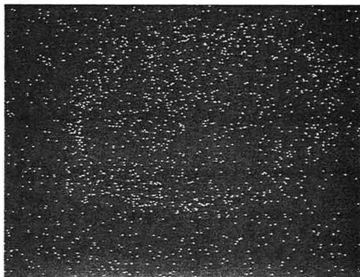
C: Image (X-Ray) caractéristique du Ba ( L_{\alpha 1} ), X800.
