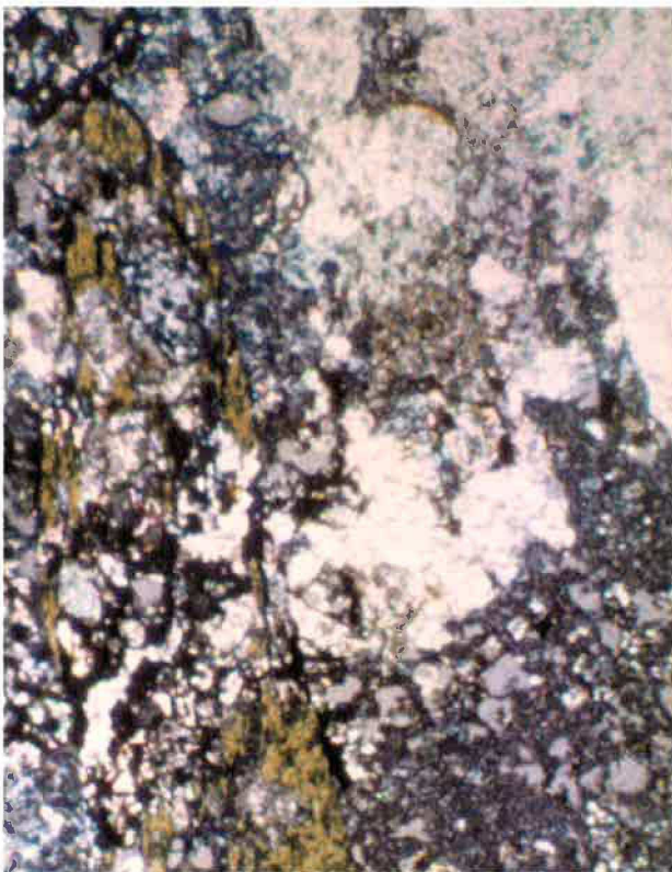
Figure 3C: Amphibole fortement altérée dans une béforsite ) à ankérite. LP, X 3.2.
