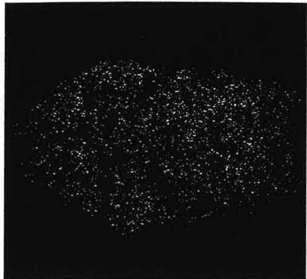
Figure VI-39B: Répartition du Ce dans le cristal de Cériopyrochlore de la photo précédente (Image RX, raie L\alpha 1, X800).
