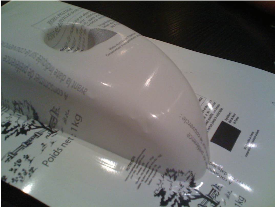
FIGURE 5.5 – Exemple de perte de couleur sur le film après le procédé de thermoformage et d'injection.
