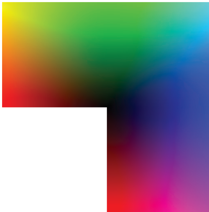
FIGURE 2.14 – Représentation plane de l'espace RVB. Le centre correspond à une intensité nulle pour chacun des trois canaux et les points du bord à une intensité maximale d'une des composantes : la composante verte pour le bord supérieur ou la bleue pour le bord droit.
