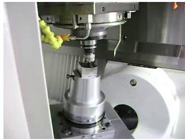
Figure 1.15 – Polissage automatique sur machine-outil
