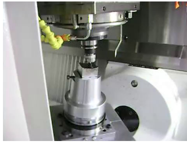
Figure 1.15 – Polissage automatique sur machine-outil
