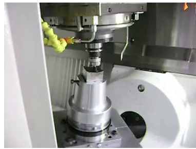
Figure 1.15 – Polissage automatique sur machine-outil
