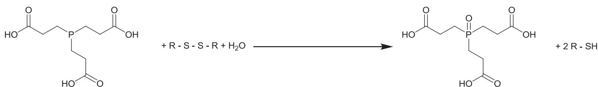
Figure IV.B.1. : Schéma réactionnel de la réduction des ponts disulfure par la TCEP
