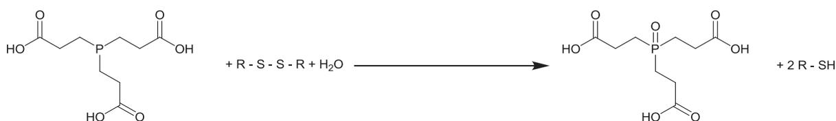
Figure IV.B.1. : Schéma réactionnel de la réduction des ponts disulfure par la TCEP
