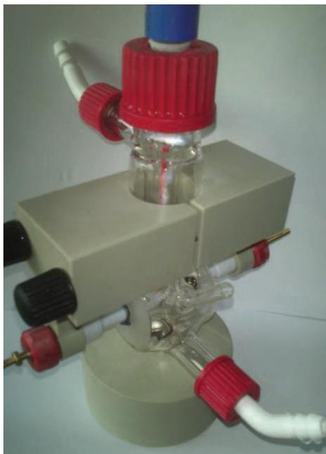
Figure E.. :Cliché de la cellule d'analyse électrochimique
