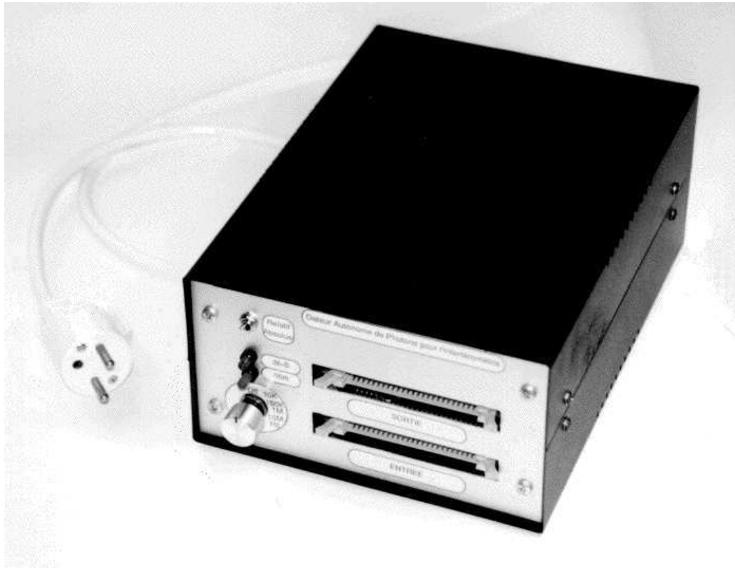
Figure VII.6. Le dateur DAUPHIN « prêt pour le service ». On distingue les connecteurs d'entrée et de sortie (respectivement en bas et en haut) des coordonnées de photons et la molette de sélection de la résolution temporelle (en bas à gauche).
