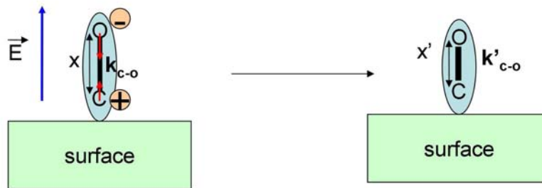
Fig. 23 : Schéma de l'effet de la charge sur l'élongation de CO.
