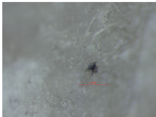
Fig. 94 Photographie sous binoculaire de résidus de fer présents sur la surface du brunissoir 127.
