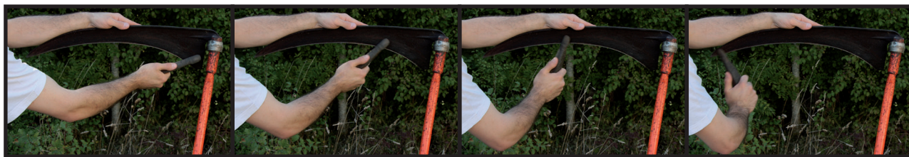
Fig. 105 Décomposition du geste d'aiguisage d'une faux à l'aide d'une pierre à faux en grès fin (photographies Manuèle Pieters).
