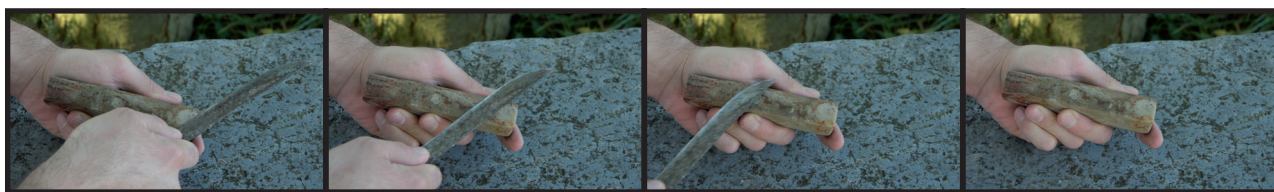
Fig. 104 Décomposition du geste de l'aiguisage d'un couteau sur un aiguisoir en grès (photographies Manuèle Pieters).
