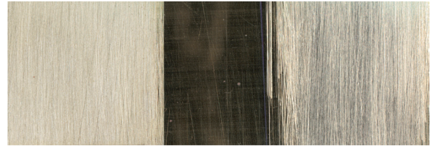
Fig. 85 Comparaison du rendu des abrasifs céramique/5/B (gauche) et grès/3/E (droite) sur une tôle de laiton (échelle 1). La zone centrale a été laissée en témoin, brute de laminoir.
