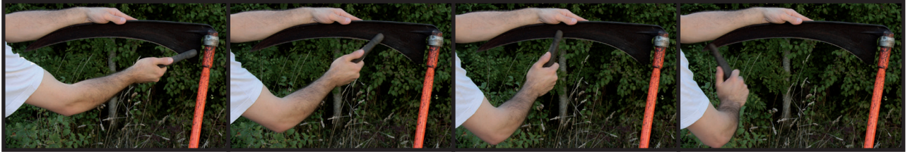
Fig. 105 Décomposition du geste d'aiguisage d'une faux à l'aide d'une pierre à faux en grès fin (photographies Manuèle Pieters).
