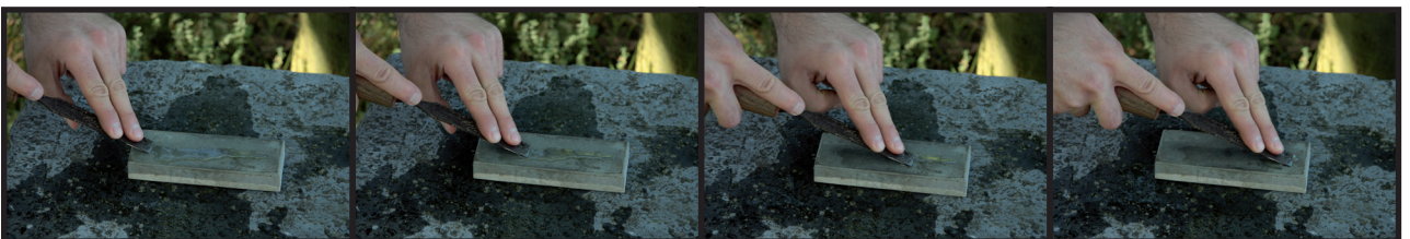
Fig. 106 Décomposition du geste d'aiguisage d'un ciseau à bois sur un meulet (photographies Manuèle Pieters).
